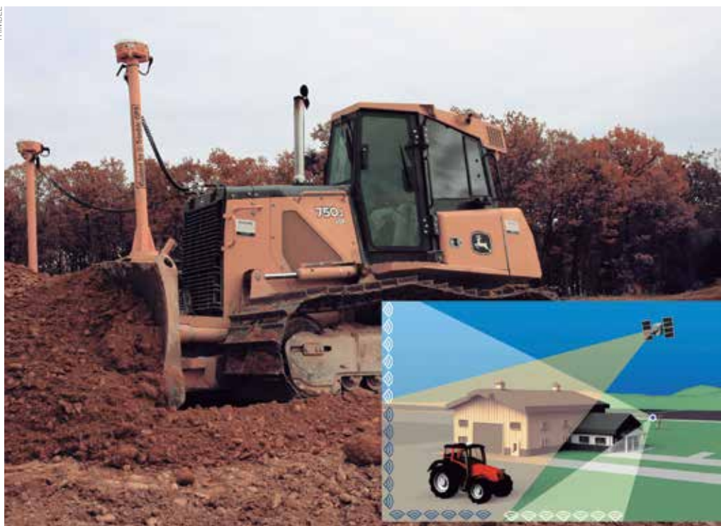
Sistemas a laser e por satélite possibilitaram a criação de projetos tridimensionais com curvas e inclinações, enquanto o equipamento obedece a comandos pré-estabelecidos, eliminando possíveis erros da interface humana
