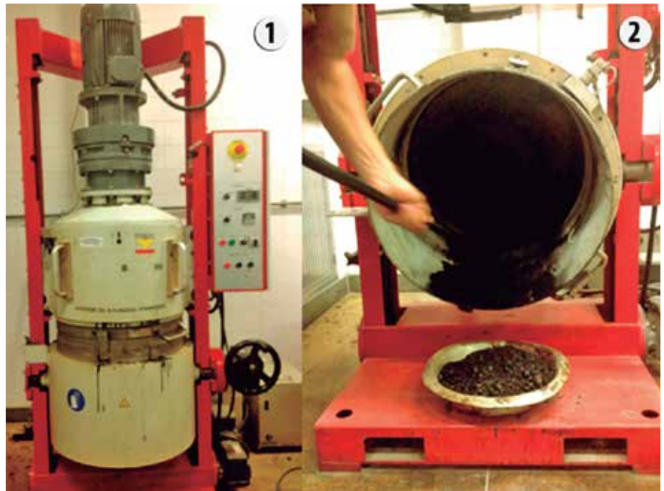
Em laboratório, o misturador apresenta força de cisalhamento inferior à da usina, tendendo a não quebrar agregados
