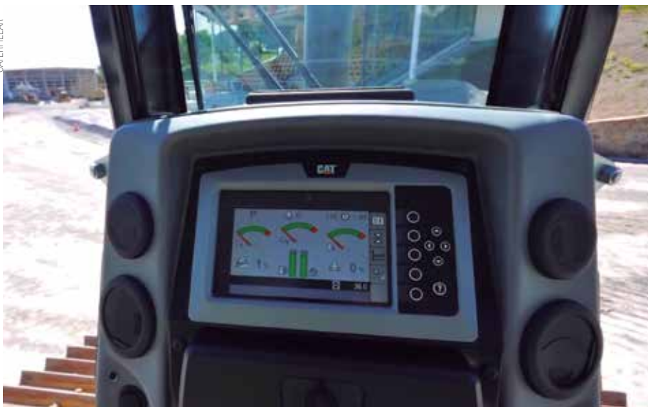
Sistemas de telemática como o Slope Assist permitiram a regulagem automática da lâmina, sem sair da máquina
