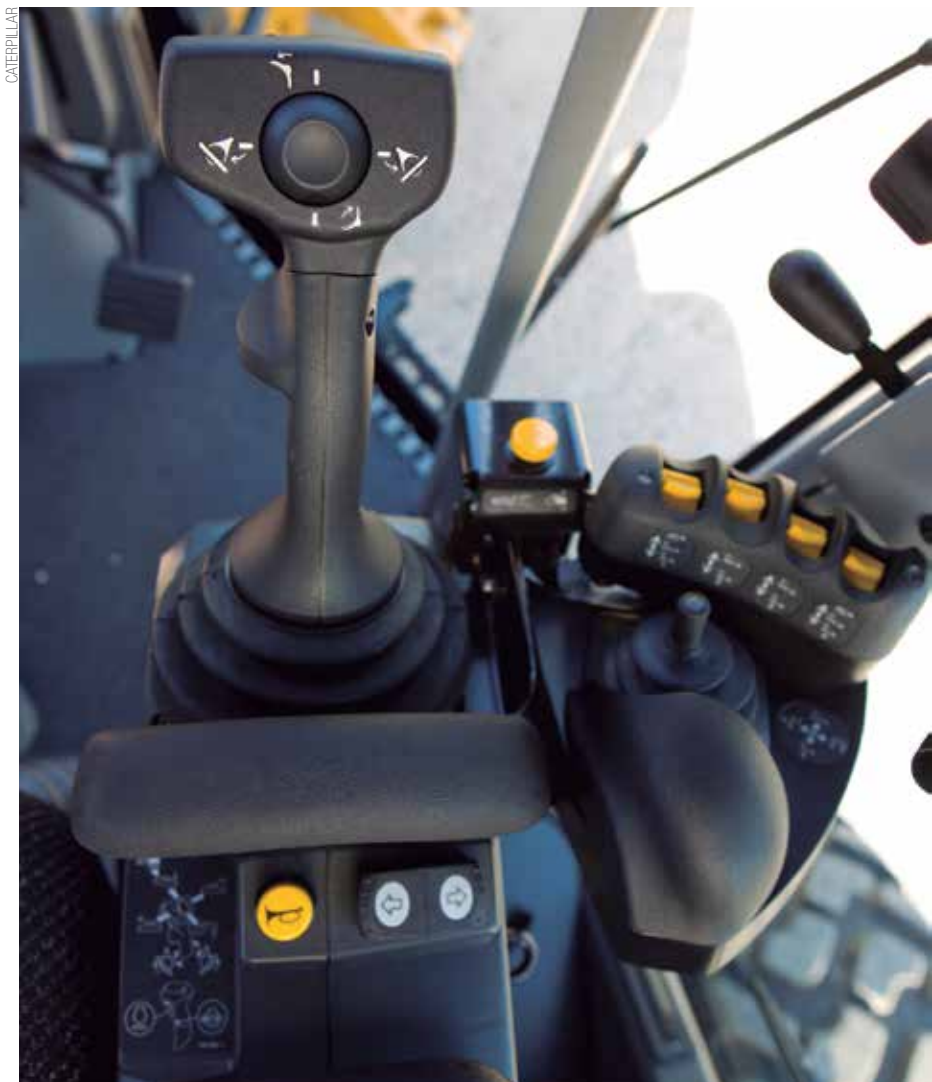
Na interface com a máquina, alavancas e conexões mecânicas deram lugar a modernos joysticks
