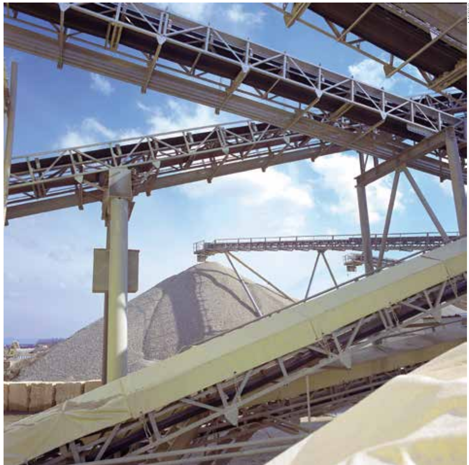
Posição de acionamento depende de variáveis da planta , como layout, espaço disponível, tamanho de estrutura, relação peso-potência e custo
