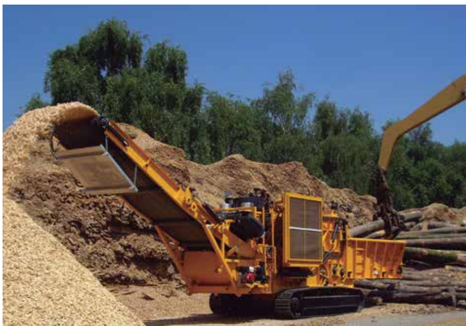
Equipamentos como este triturador de madeira autopropelido CBI 6400
