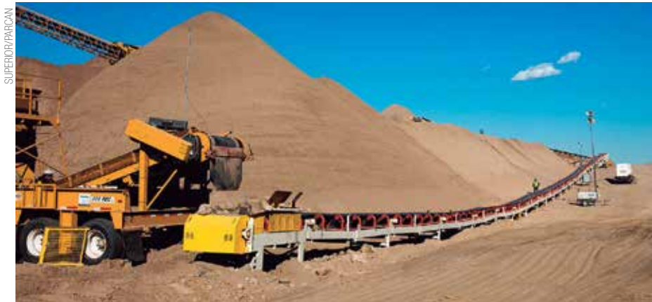
Correias com carcaça de lona e com alma de aço são as mais utilizadas em mercados como mineração
