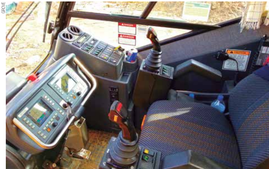
Em guindastes, os projetos de cabinas privilegiam visão da carga e buscam minimizar pontos cegos para o operador
