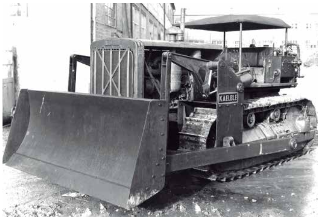
Lançado em 1939 , o Kaelble R125 foi o primeiro trator produzido especificamente para terraplanagem na Alemanha
