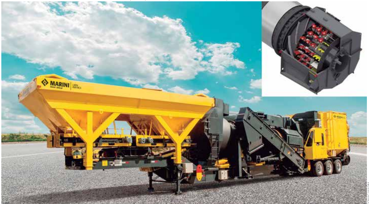
Usinas da série Titanium trazem misturador externo rotativo (detalhe) e secador para trabalharem com alta capacidade de RAP
