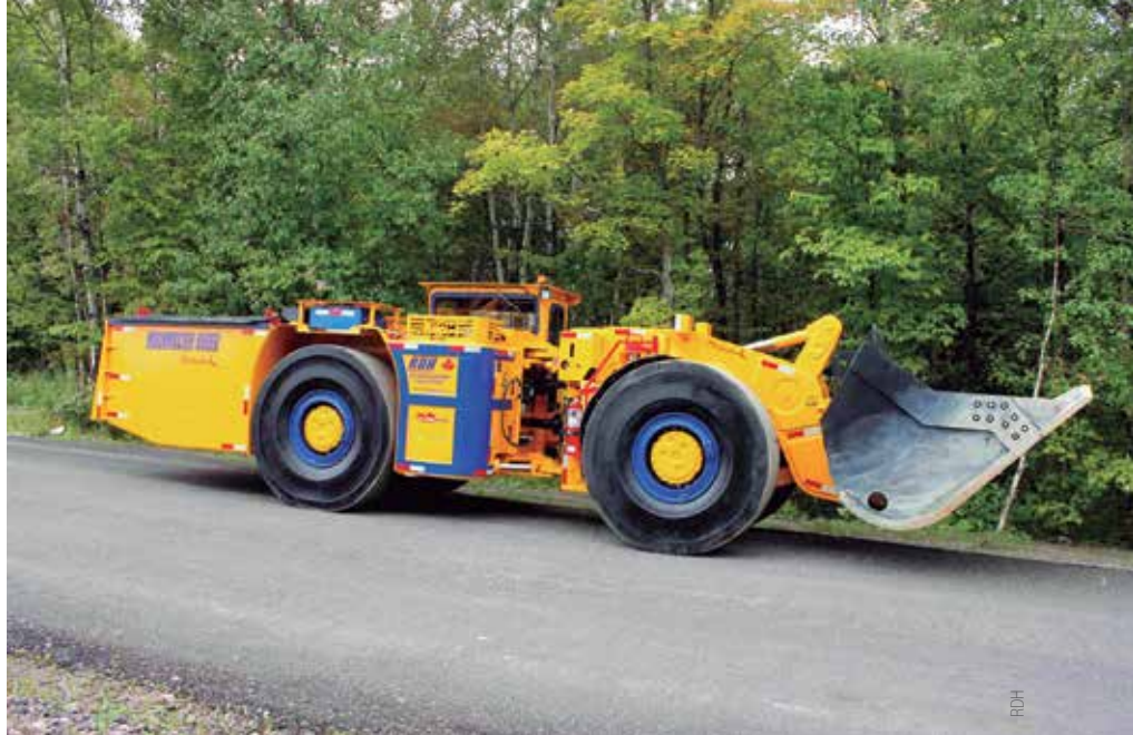
Movido a bateria , o modelo Muckmaster 600EB possui caçamba com capacidade de 3,4 a 5,4 m 3
