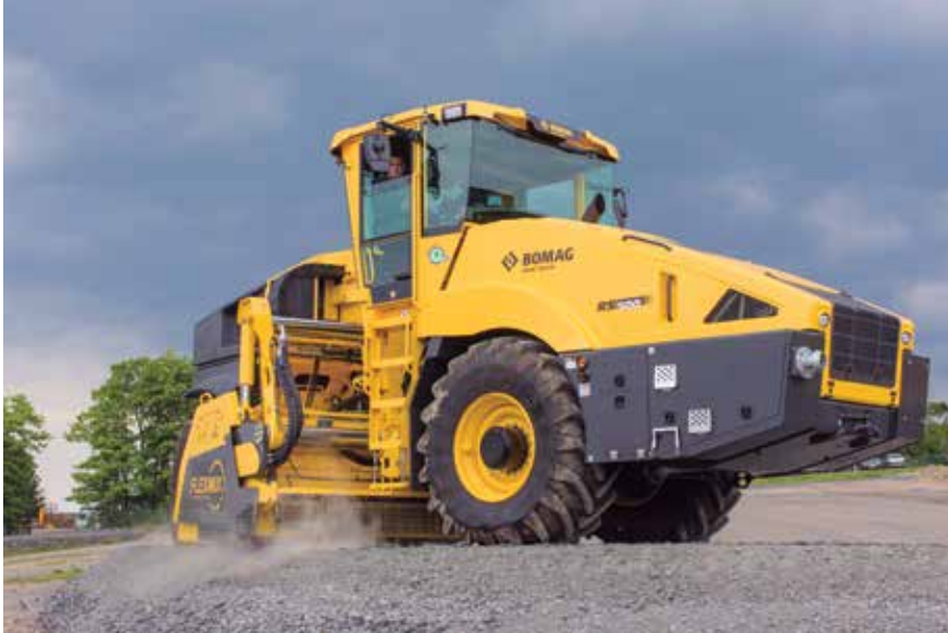
Deslocamento lateral do rotor de fresagem é o ponto forte da RS500, a nova opção da Bomag em recicladoras
