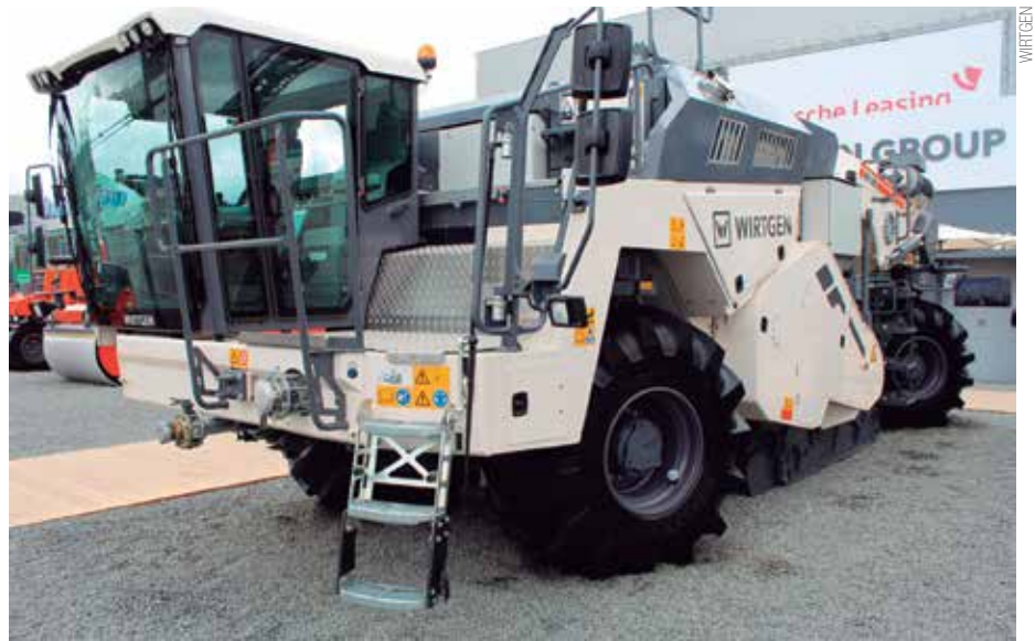
Modelo Wirtgen WR 240 permite o trabalho em uma única faixa rodoviária, sem necessidade de bloqueio total da via
