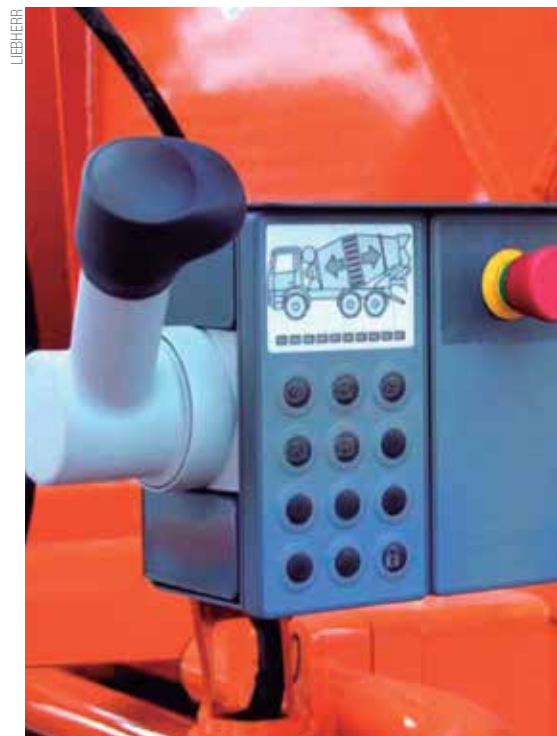
Sistema de acionamento EMC garante que as rotações do tambor permaneçam constantes
