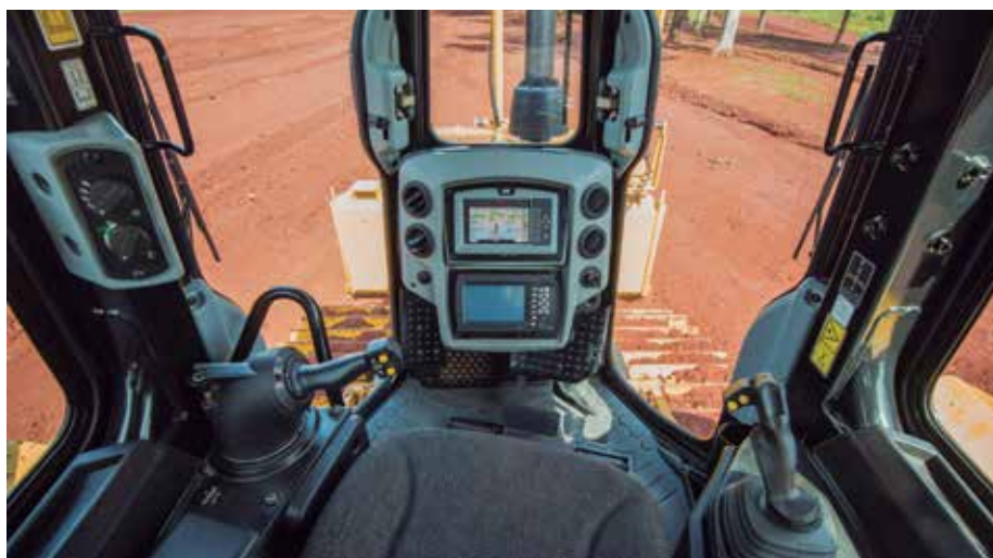
Cabine ganhou display em LCD, modernizando e reposicionando os controles dos novos tratores
