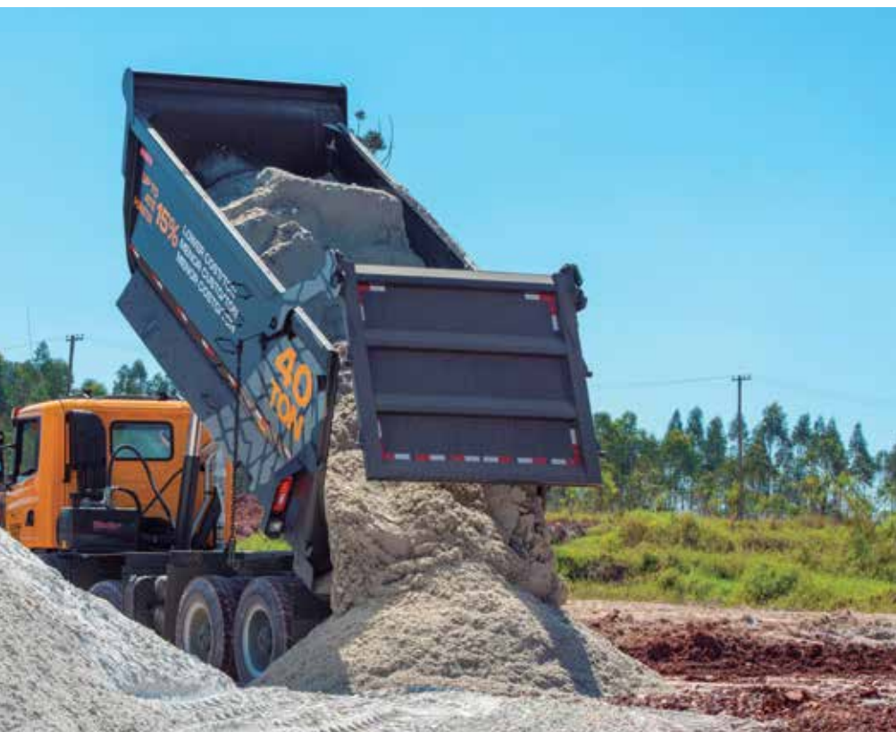
Por meio de alterações estruturais do projeto, novo modelo Scania Heavy Tipper ganhou 25% em capacidade de carga
