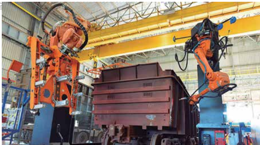
Célula robotizada agiliza recomposição de chapas de vagões em Carajás
