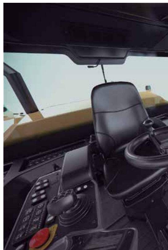
Mais espaçosa , cabine do CW34 conta com assento deslizante e giratório de 90 graus para qualquer direção
