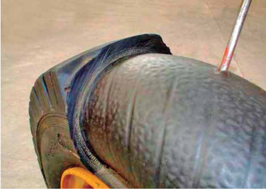
Aplicado na carcaça, o elastômero mantém a calibragem durante toda a vida útil do pneu
