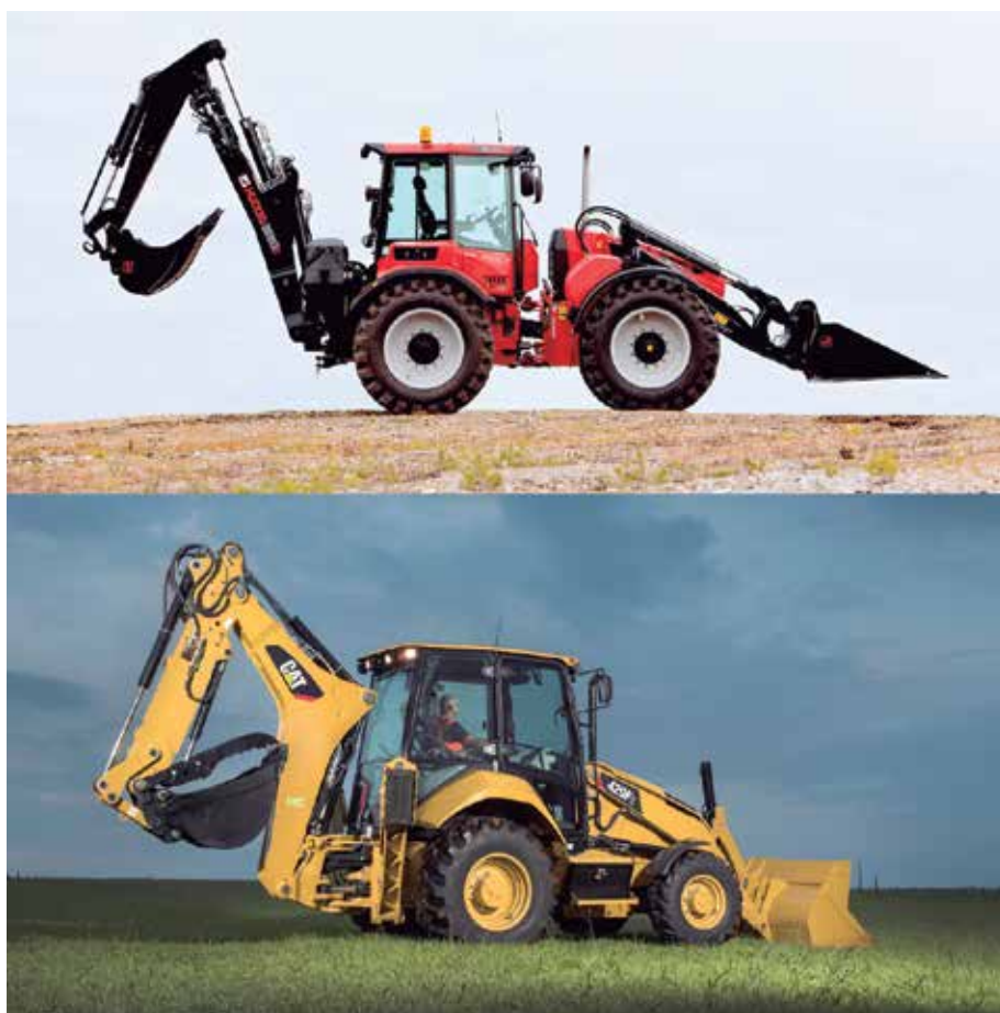
Principal diferença na estrutura da articulada está na presença de um pivô entre os eixos dianteiro e traseiro
