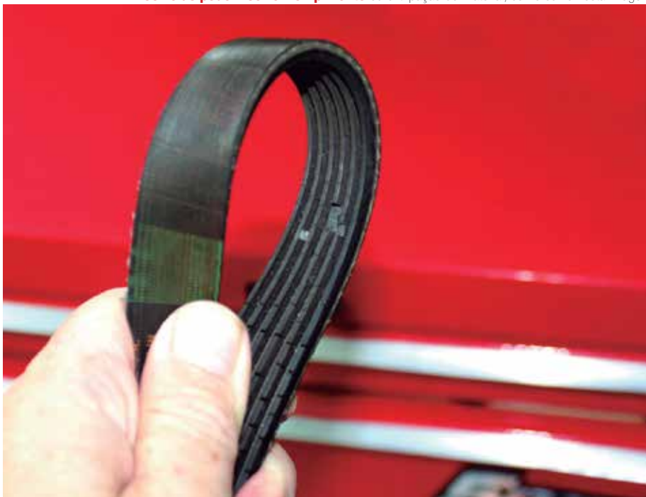
Correias podem sofrer rompimento ou extirpação de material, como se vê nesta imagem
