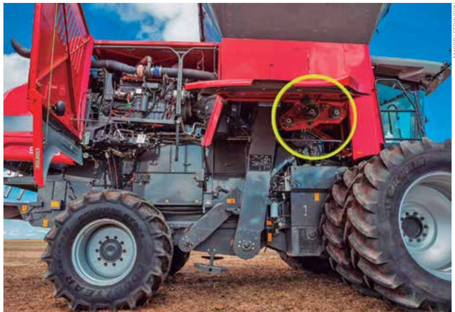
Além de cuidados preventivos, as correntes (no destaque) requerem dimensionamento adequado à operação
