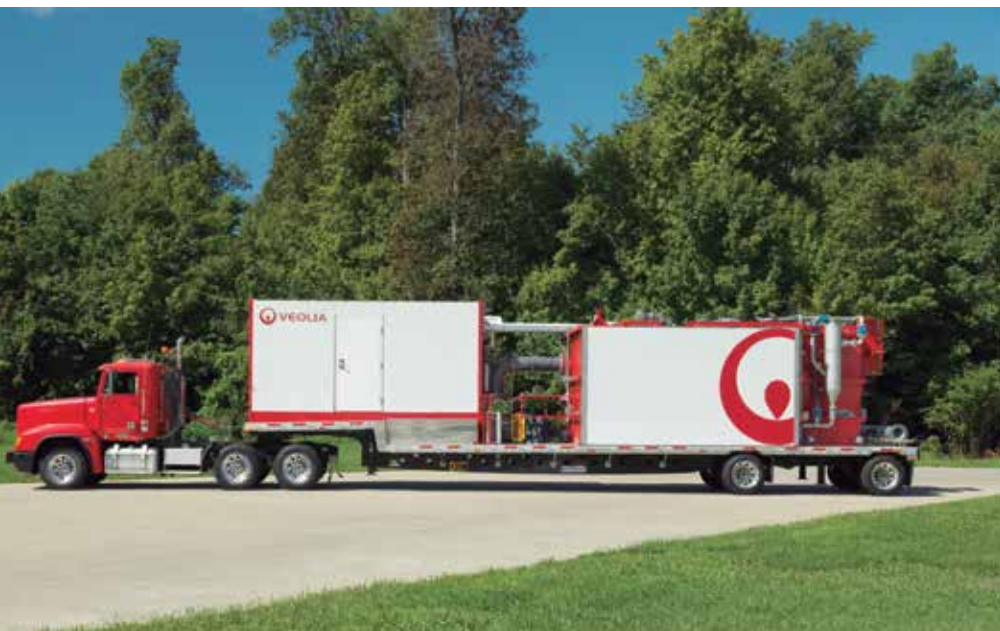
Trafegando em uma carreta, estação móvel de reúso da Veolia tem capacidade para 300 m³/h de água
