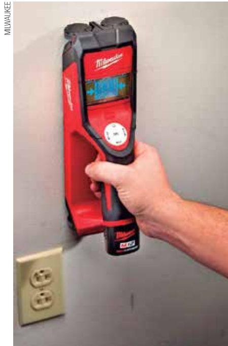
Equipamentos podem ser aplicados na detecção de colunas de fixação em diversos tipos de paredes
