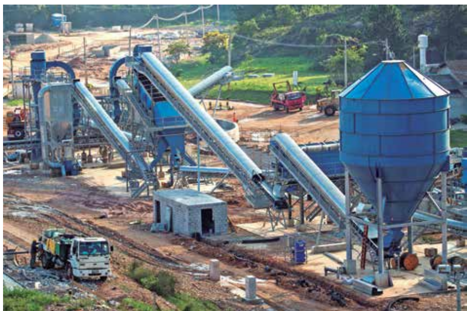
Capacidade média de usinas de britagem como esta, na região metropolitana de São Paulo, pode ultrapassar 100 t/h
