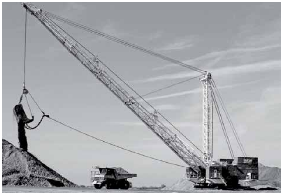
Apelidado de “Rei Midas” , o modelo Bucyrus-Erie 680-W era um dragline de 19 m 3 equipado com lança de 68,5 m
