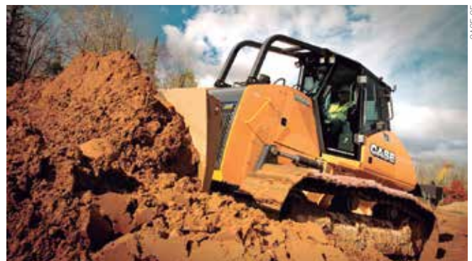
Trator de esteiras requer rotina de limpeza semanal e reaperto periódico dos parafusos
