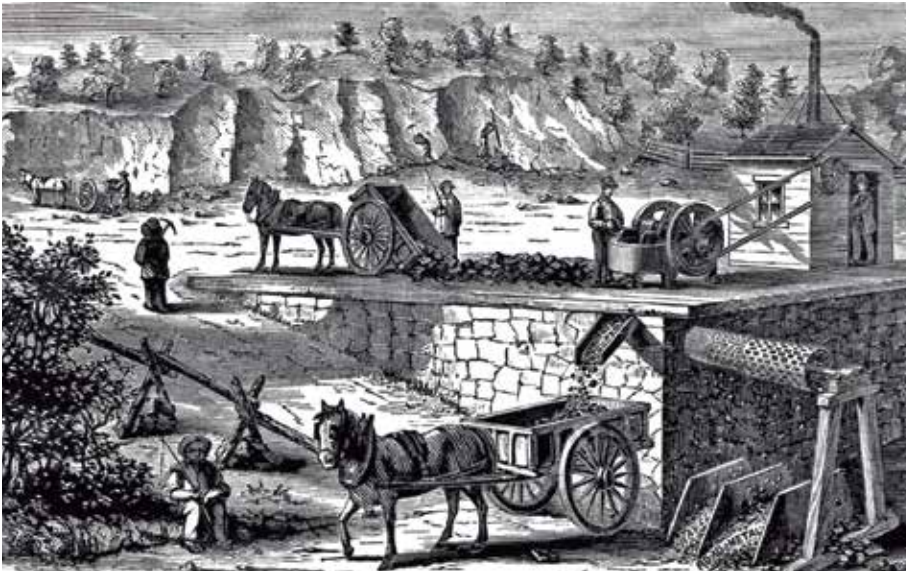
Ilustração de época mostra estação de britagem embasada no conceito de Eli Whitney Blake
