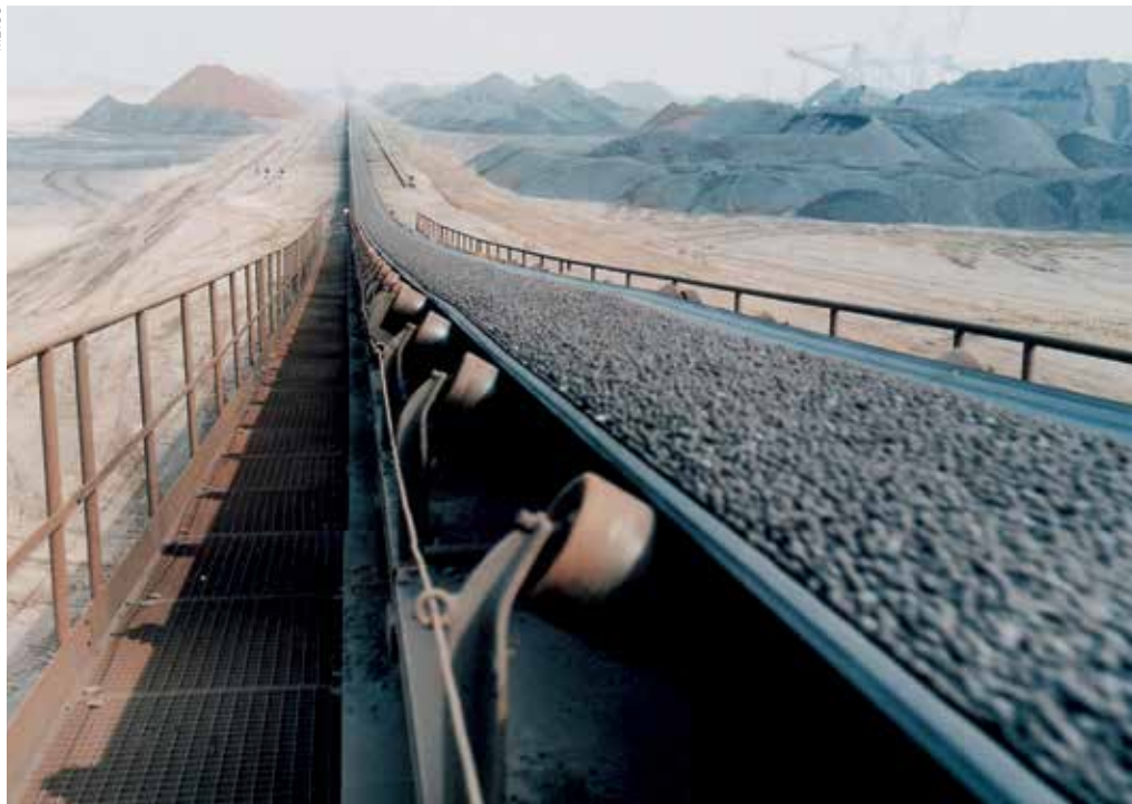
Opção entre a correia de fibra ou com cabos de aço depende prioritariamente do tipo de instalação
