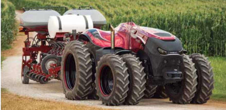
Trator autônomo une novas tecnologias em orientação, telemetria, compartilhamento de dados e gerenciamento
