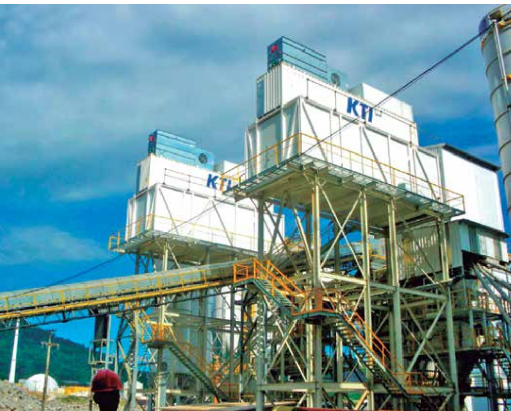
Refrigeração do concreto é adotada em obras como a de Angra III
