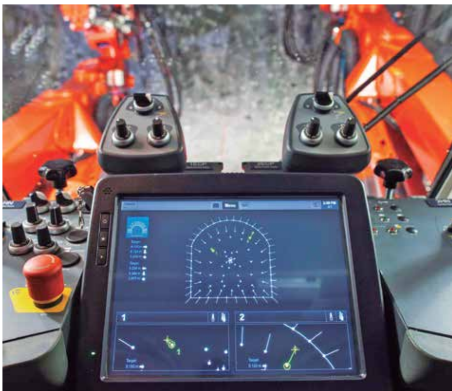
Sistema TCad+ permite controle efetivo sobre a localização de cada furo
