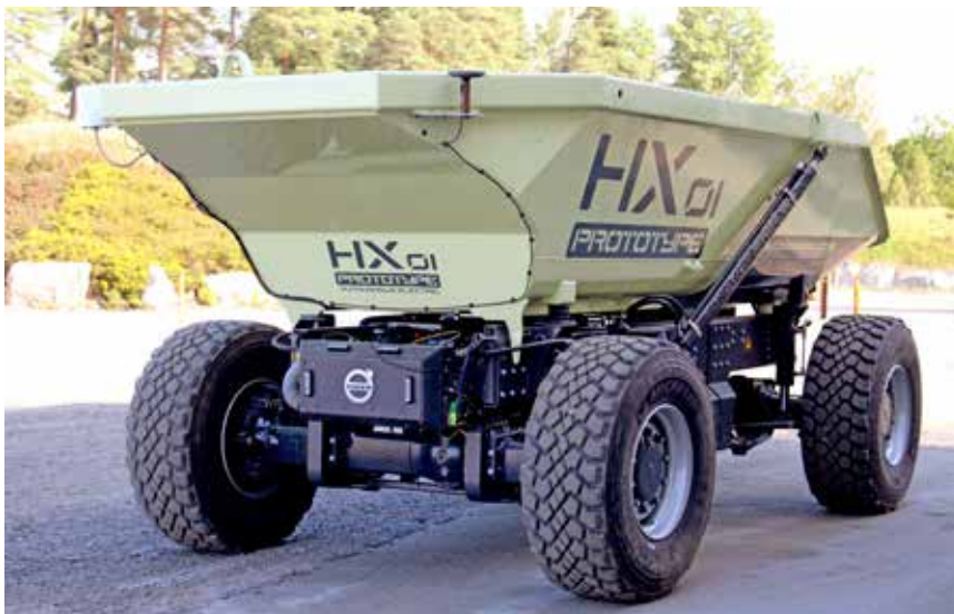
Protótipo autônomo HX1 integra projeto de eletrificação dos canteiros
