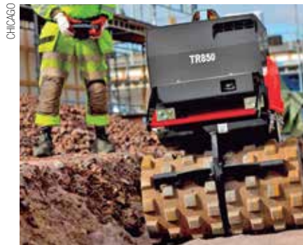
Rolos para valas nunca devem ser rebocados, alerta fabricante
