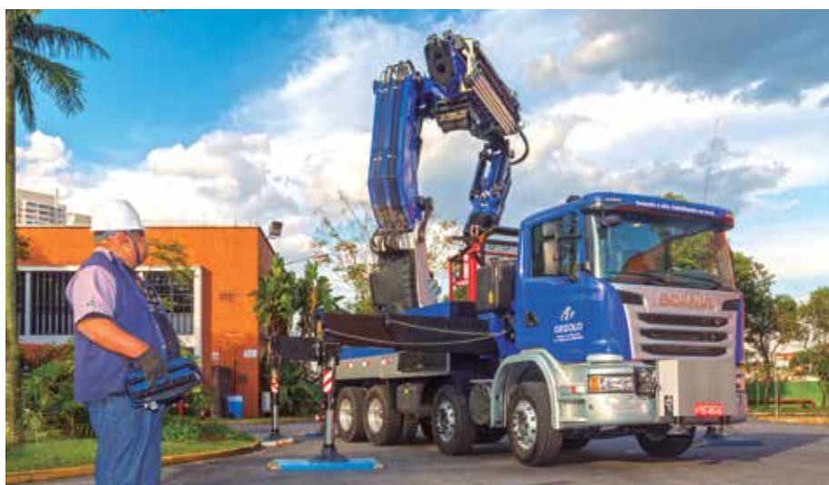
Guindaste Fassi F1950 é montado em caminhão fora de estrada Scania G 440 8x4
