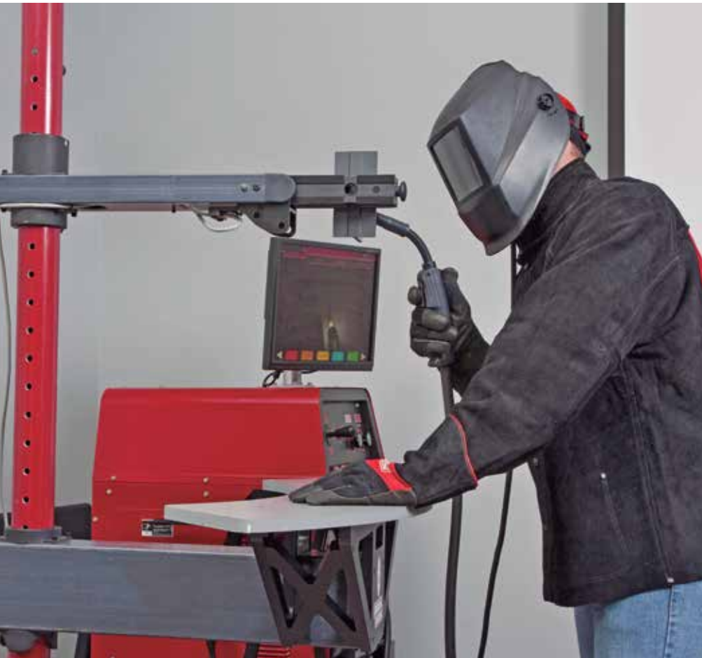
Simulador é composto por máscara de solda, tochas específicas, bancada, suporte de fixação e materiais
