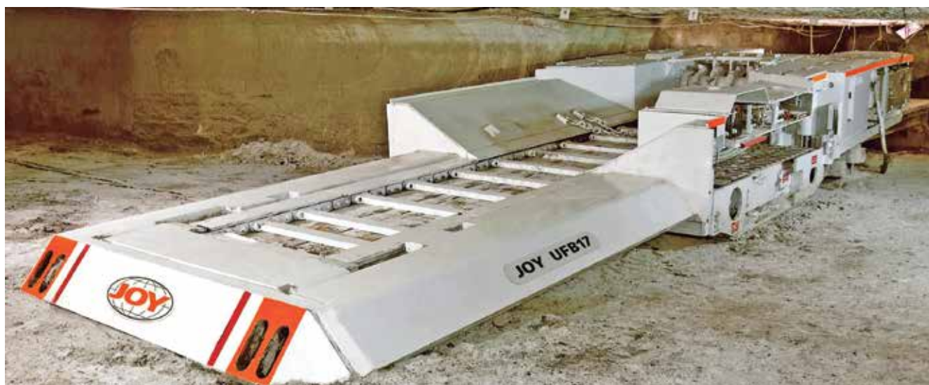
Uso de feeder breaker dispensa caminhões
