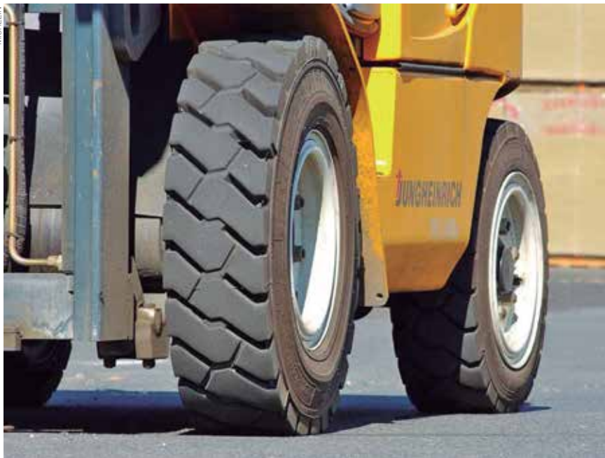
Pneu Michelin XZM é específico para operação em indústrias, portos e aeroportos
