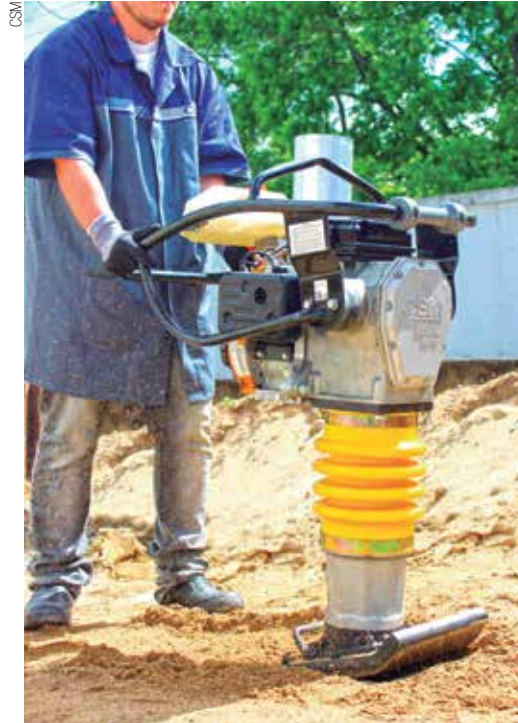
Compactadores do “tipo sapo” oferecem maior velocidade e agilidade nas obras
