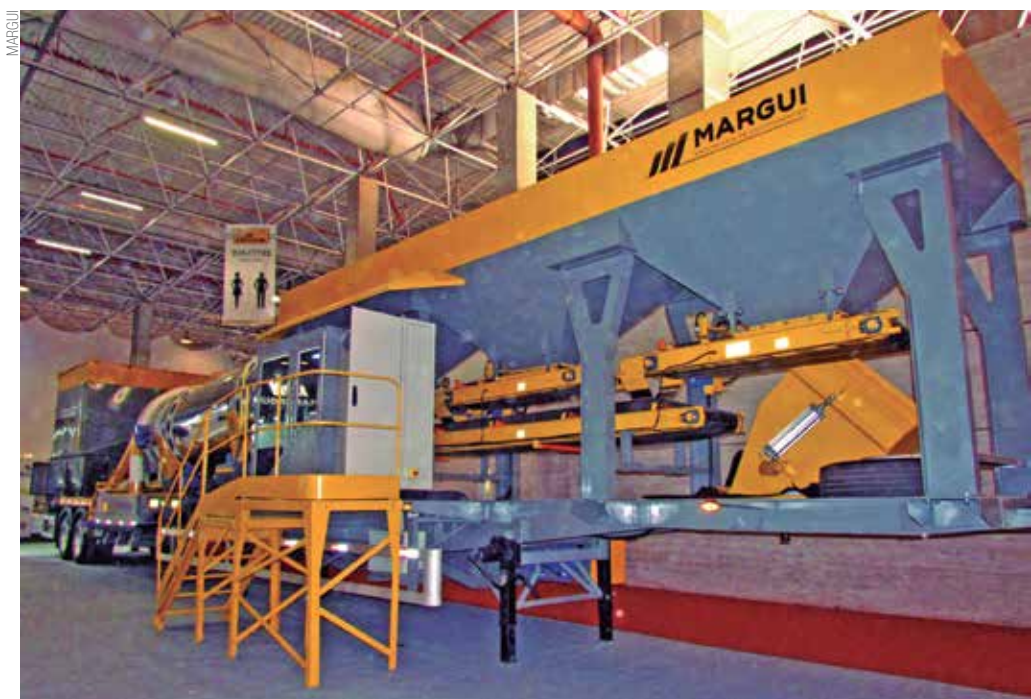
Microusina de asfalto é fabricada em chassi único e rebocável
