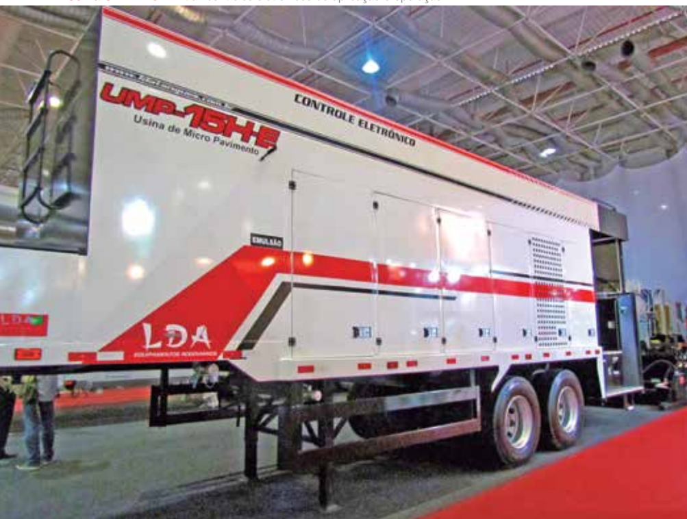
Usina UMP-115H-E traz controles eletrônicos de aplicação e operação
