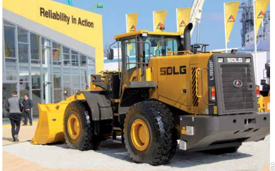
Pá carregadeira L968F ganhou núcleo hidráulico centralizado
