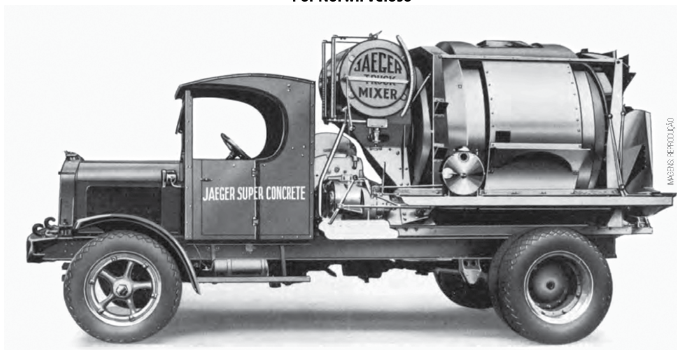
A aurora da indústria do concreto: caminhão betoneira Jaeger fabricado na Inglaterra por Ransomes & Rapier
