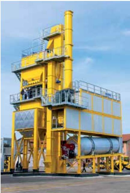
Usina de asfalto Be Tower tem produção de até 160 t/h
