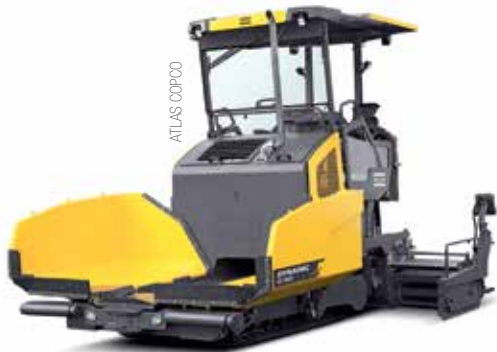
Pavimentadora SD1800C tem aplicação em vias urbanas
