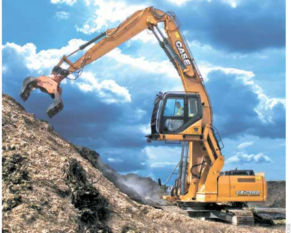
Modelo de esteiras CX290D é voltado para manipulação de materiais
