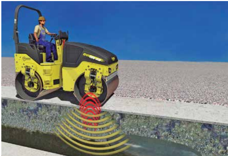
Sistemas realizam a parametrização, detecção de falhas e registro dos dados da operação
