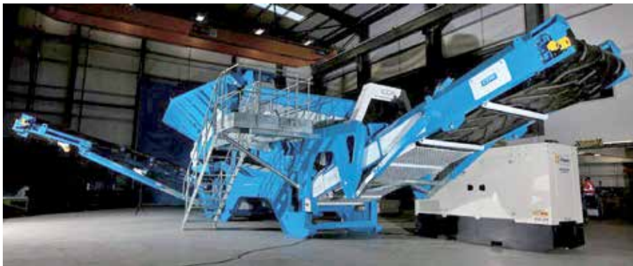
Unidade de peneiramento R2500 tem capacidade de 500 t/h
