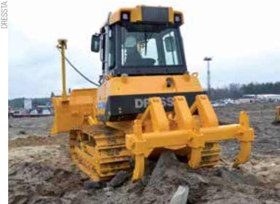
Dozer TD-9S oferece capacidade da lâmina de 2,2 m 3
