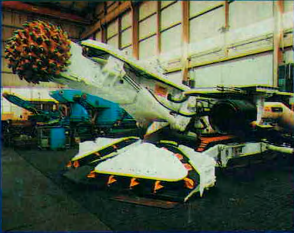
FRESADORAS DE 40 A 500 KW DE POTÊNCIA DE CORTE
