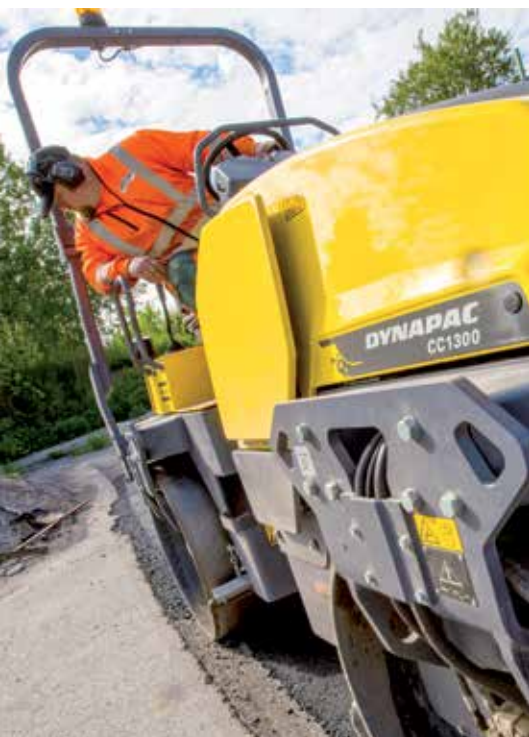
Equipamento influencia diretamente na textura de acabamento superficial da camada
