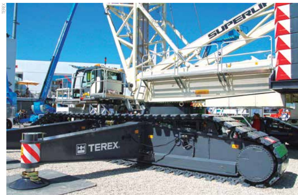
Modelos de esteiras com lança treliçada têm a vantagem de se movimentar com a carga
