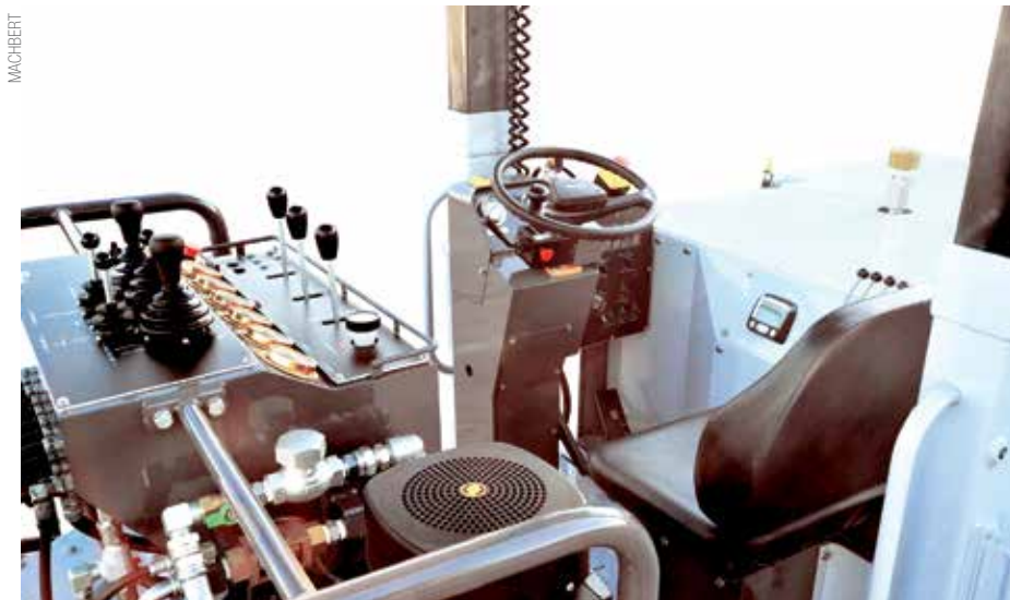
Jumbos de construção requerem sistemas de controle da amplitude de escavação
