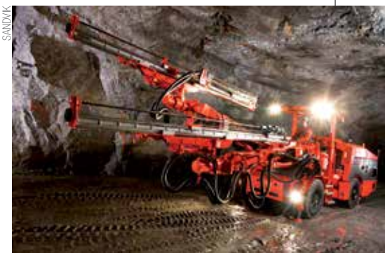
Perfuração exploratória detecta falhas nos maciços
