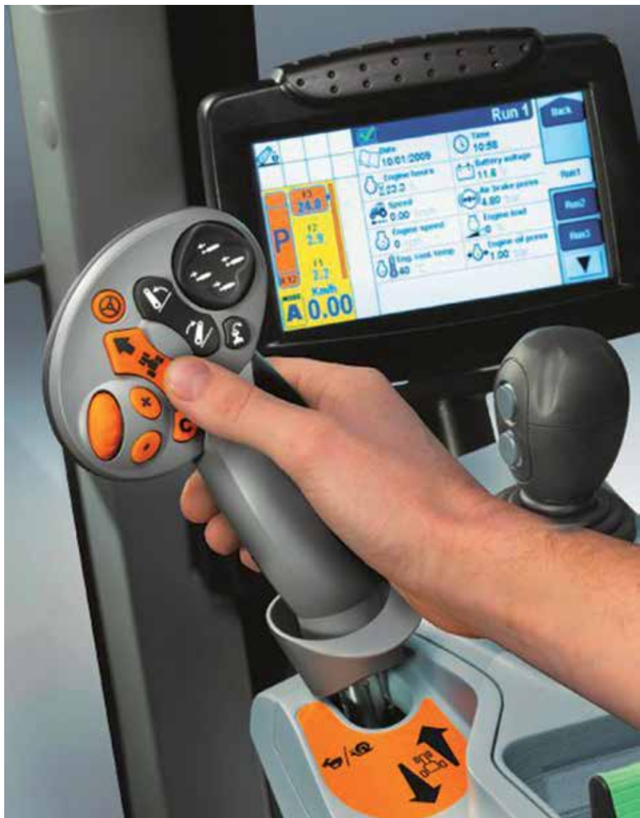
Joystick tem a vantagem de preservar o operador em longos períodos de atividade
