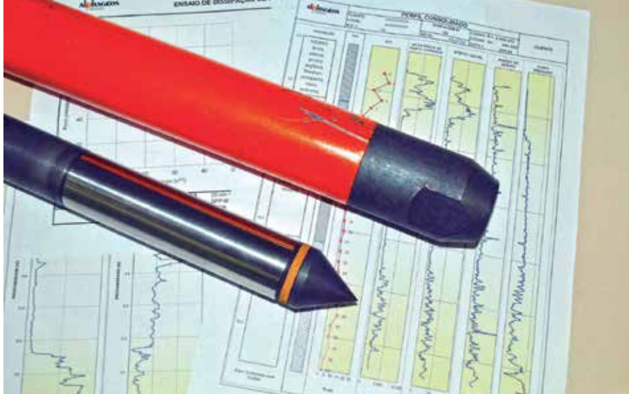
Cones utilizados na técnica de CPTu medem o atrito no solo por meio de circuitos eletrônicos
