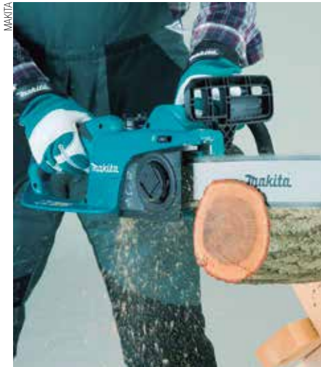
Dimensionamento do comprimento do sabre é fator determinante para eficácia da operação
