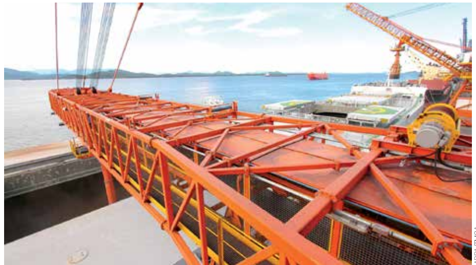
Cada carregador do no shiploader pode movimentar 3 mil t/h
