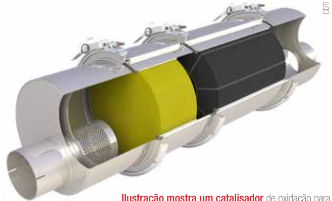
Ilustração mostra um catalisador de oxidação para motor diesel DOC (em amarelo) à frente de um filtro particulado (DPF), instalados em um conversor catalítico para caminhões
