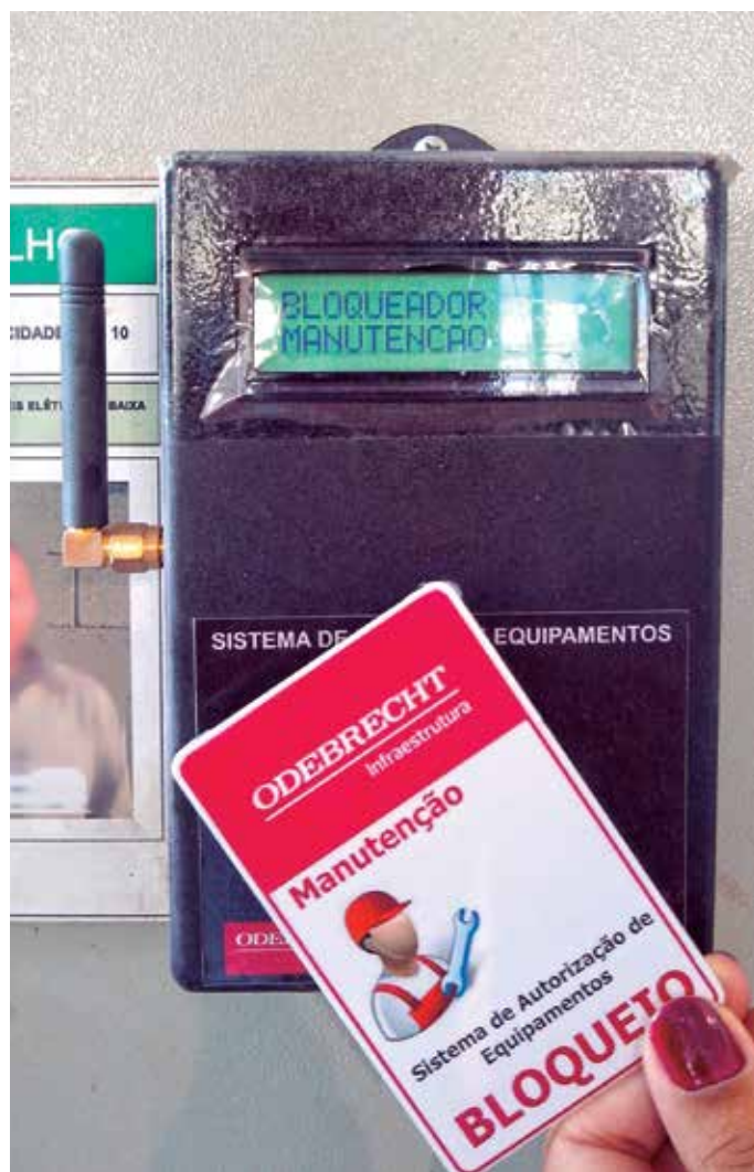
Monitoramento: validação de cartão funcional no leitor ótico do módulo
