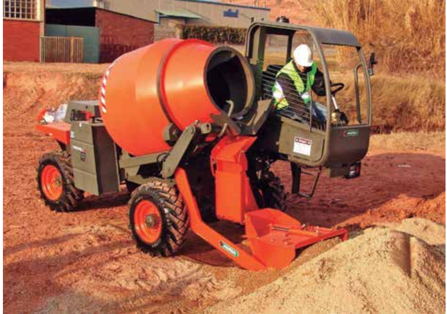
Possibilidade de transportar o concreto até a frente de trabalho é outra vantagem
