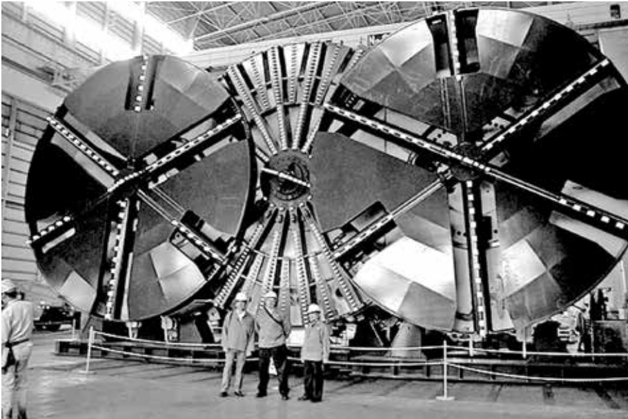
Utilizada originalmente na construção do metrô de Osaka, a TBM tripla da Hitachi representou uma inovação de impacto na indústria de equipamentos
