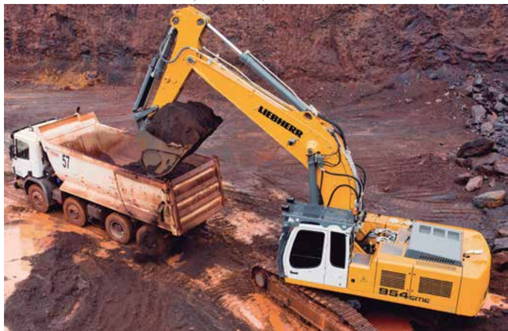
Escavadeira Liebherr R 954 C SME recebe caçamba maior sem perda de estabilidade
