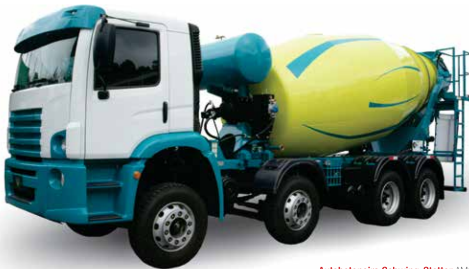
Autobetoneira Schwing-Stetter AM10FHC transporta até 10 m 3 de concreto
