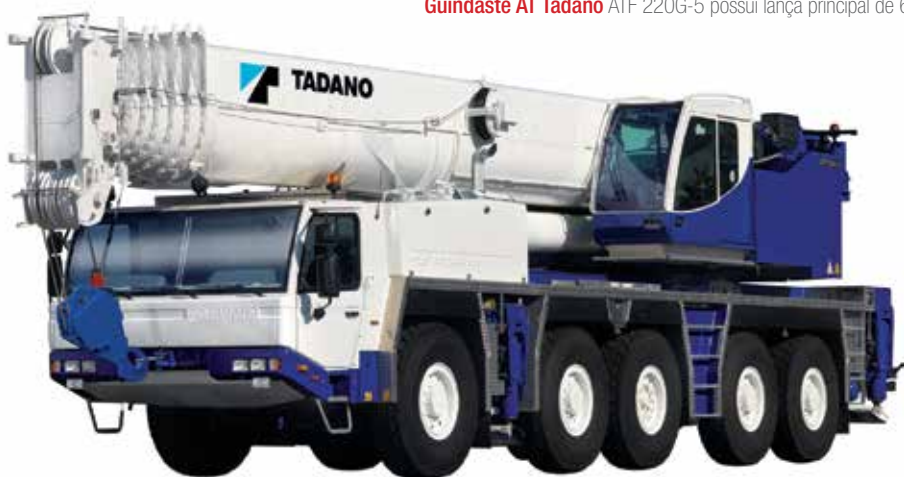
Guindaste AT Tadano ATF 220G-5 possui lança principal de 68 m
