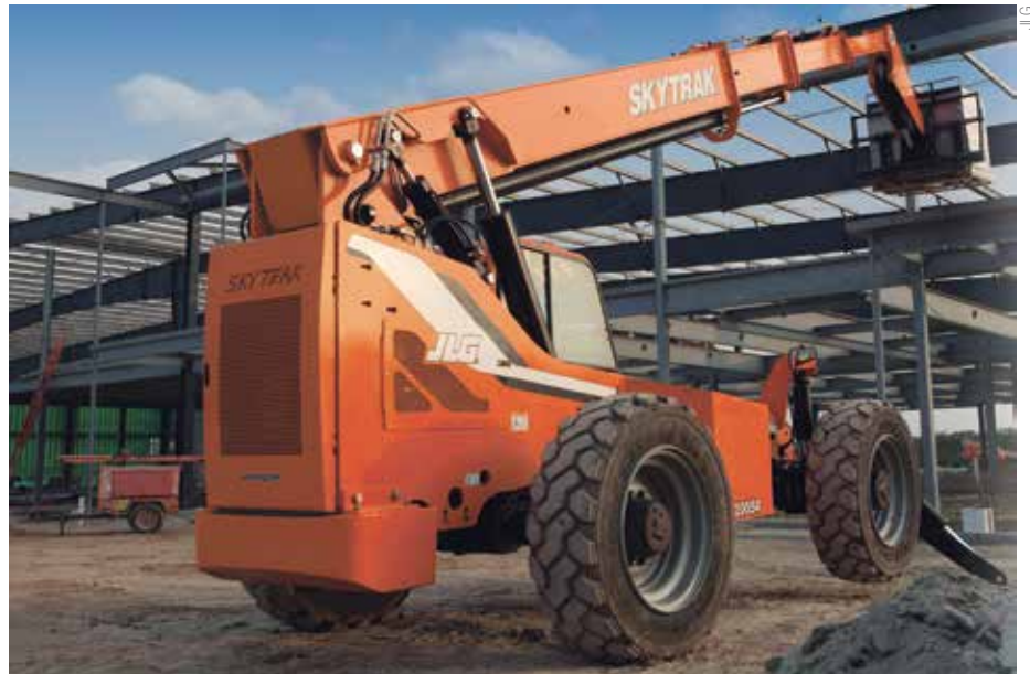
Lança telescópica pode ser estendida à frente e acima do veículo
