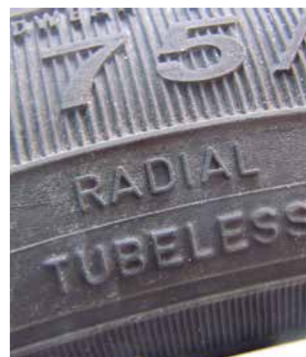
Fig. 3: indicação de ausência de câmara
