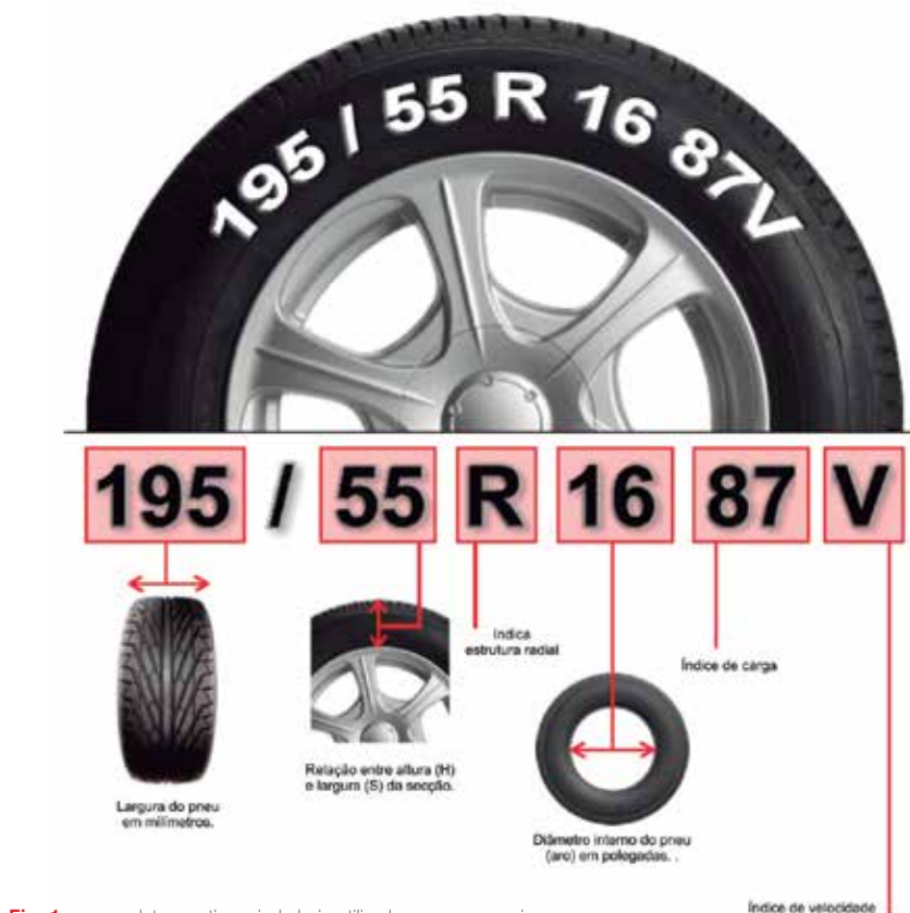
Fig. 1: nomenclatura antiga, ainda hoje utilizada em pneus maiores
