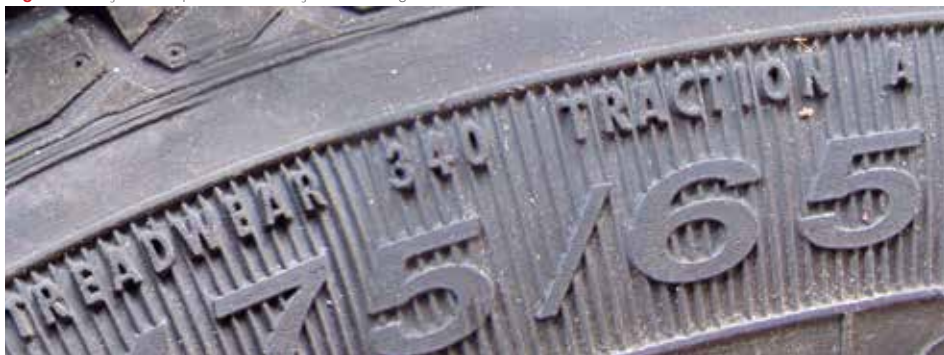
Fig. 5: indicação de capacidade de tração e de desgaste
