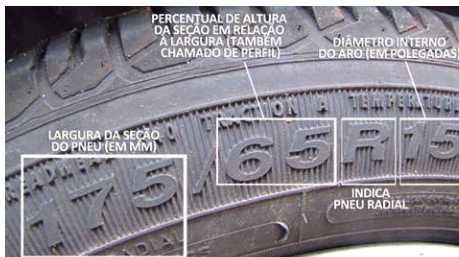
Fig. 2: nomenclatura atual, com especificações de largura, altura e diâmetro
