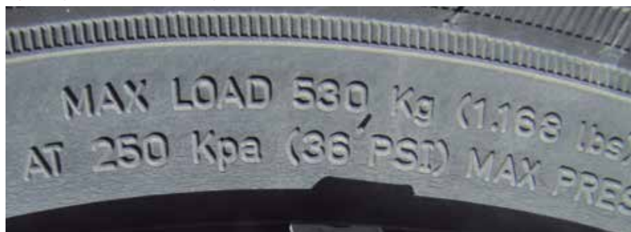
Fig. 7: carga e pressão indicadas em kg e kPa
