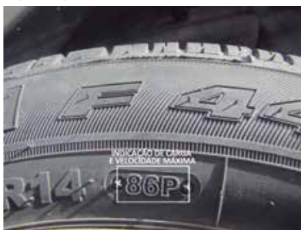
Fig. 6: carga e velocidade indicadas por letras e números
