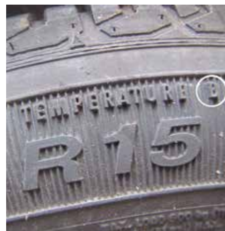
Fig. 8: resistência à temperatura e faixa de trabalho
