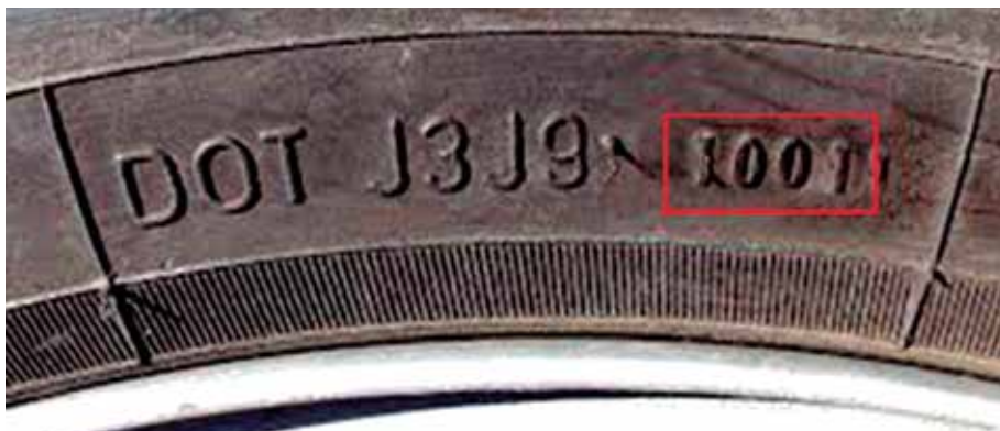
Fig. 4: data de fabricação com quatro algarismos (semana e ano)
