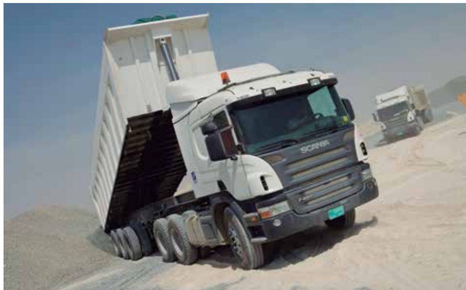
Tomadas de força acionadas indevidamente implicam risco de segurança para caminhões basculantes
