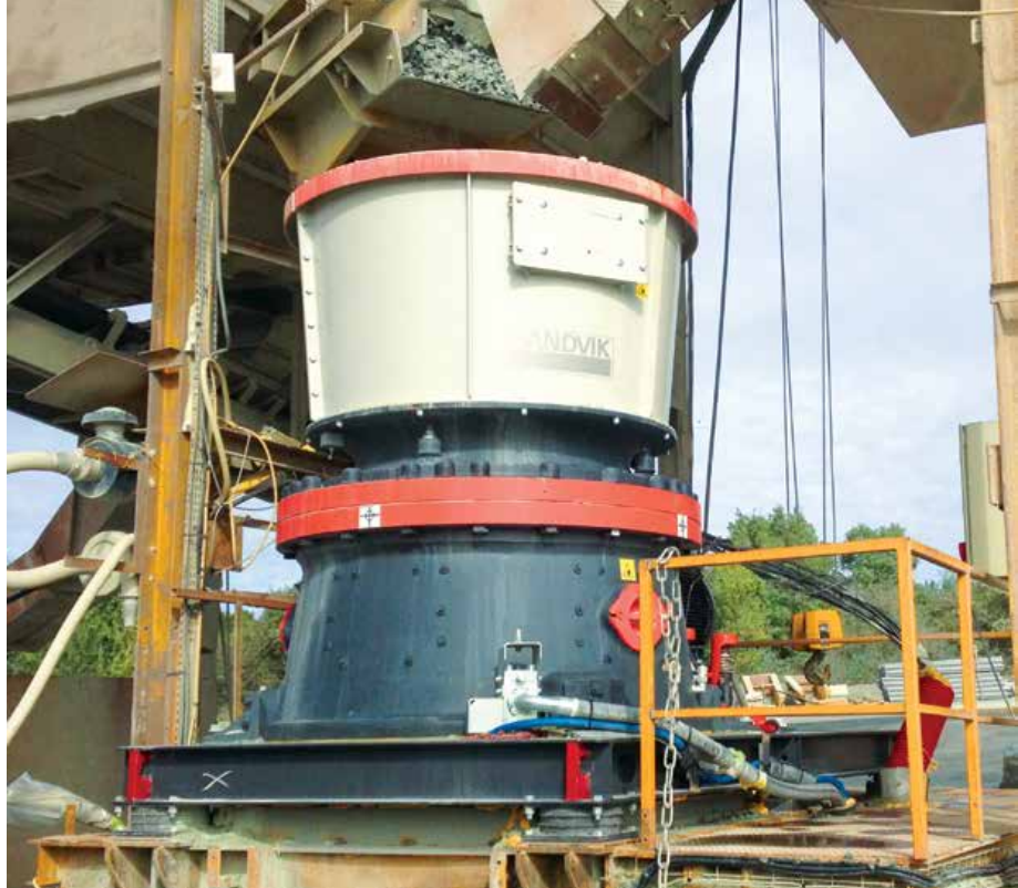
Automatizados , equipamentos da Sandvik permitem a utilização de várias opções de excentricidade e ajustes
