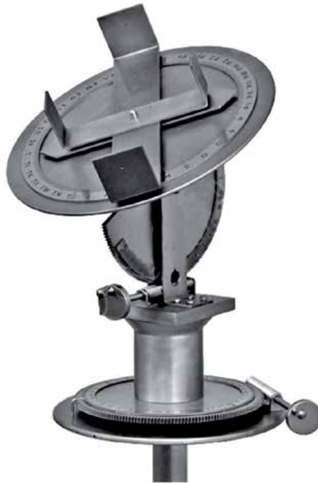
A dioptra , inventada pelo geômetra e engenheiro grego Heron de Alexandria (10 d.C. -80 d.C.)
