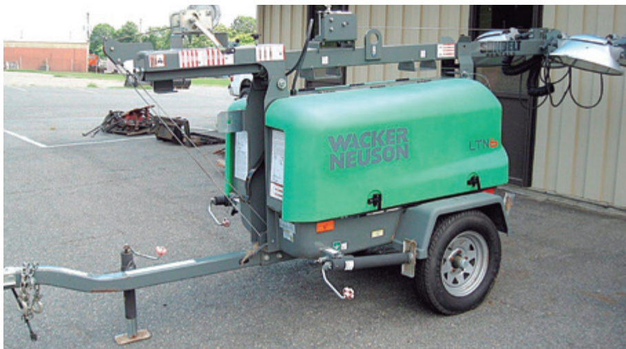
Modelo de torre sobre reboque permite ajuste para facilitar o transporte e armazenagem
