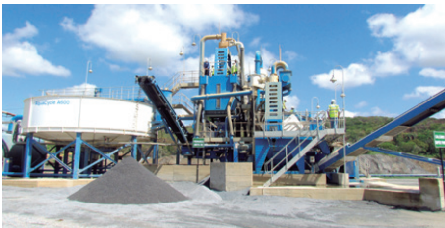
Tendência em pedreiras é de processar a própria areia, levando à necessidade de reciclar a água
