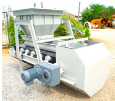
Modelo de correia: estrutura simples
