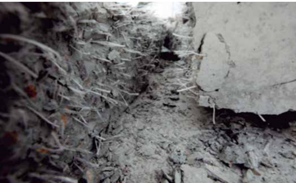
Mais leves e elásticas que o aço, macrofibras ainda caminham a passos curtos no Brasil
