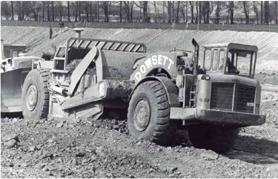
O scraper Terex TS-24, flagrado nesta imagem de 1984 na Etiópia, tinha capacidade de 18,3 m 3 e deixava uma nuvem massiva de poeira em seu rastro
