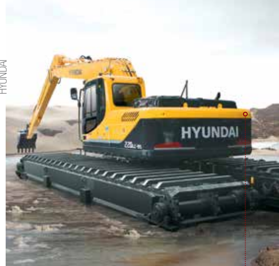
Escavadeira anfíbia possui flutuadores
