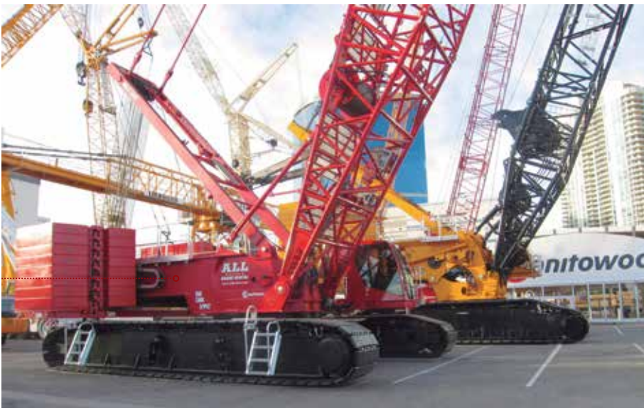
Equipamento com sistema de contrapeso de posição variável destacou-se no evento
