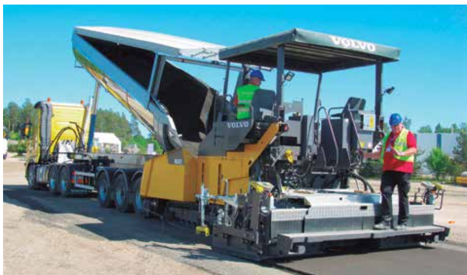
Vibroacabadoras da linha ABG possuem sistema eletrônico de tração hidrostática EPM II
