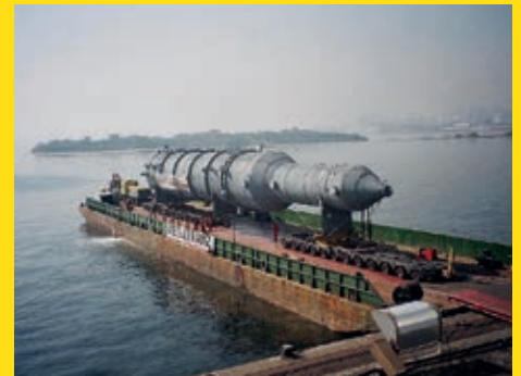
Conjunto Transportador Mega Viga Modular STB-1000 Scheuerle com 22 x 22 linhas de eixo e Power Booster Capacidade Máxima de Carga – 1.000 ton
