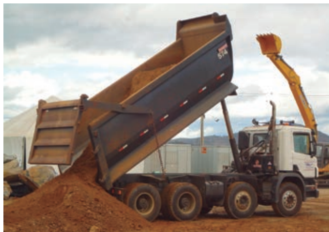
Cilindros hidráulicos integram quase todos os equipamentos móveis utilizados na construção e mineração
