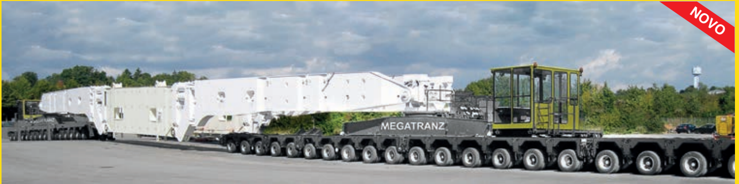
Conjunto Transportador Mega Viga Modular STB-1000 Scheuerle com 22 x 22 linhas de eixo e Power Booster Capacidade Máxima de Carga – 1.000 ton
