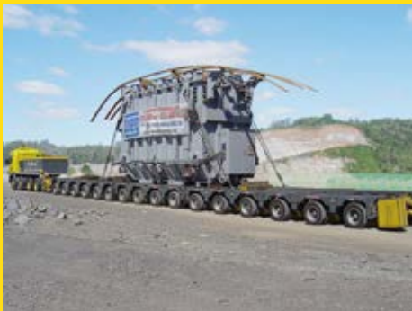
Conjunto Transportador Mega Viga Modular STB-1000 Scheuerle com 22 x 22 linhas de eixo e Power Booster Capacidade Máxima de Carga – 1.000 ton
