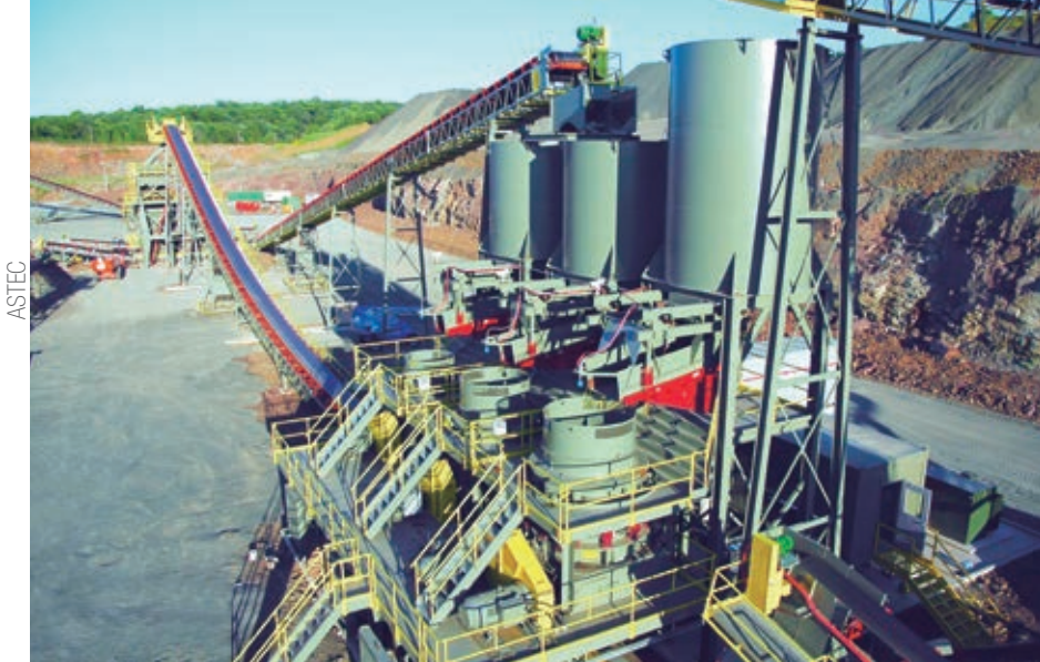
Definição da linha de britagem requer análise de capacidade, granulometria, material, operação e outras
