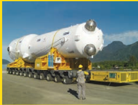
Conjunto Transportador Mega Viga Modular STB-1000 Scheuerle com 22 x 22 linhas de eixo e Power Booster Capacidade Máxima de Carga – 1.000 ton
