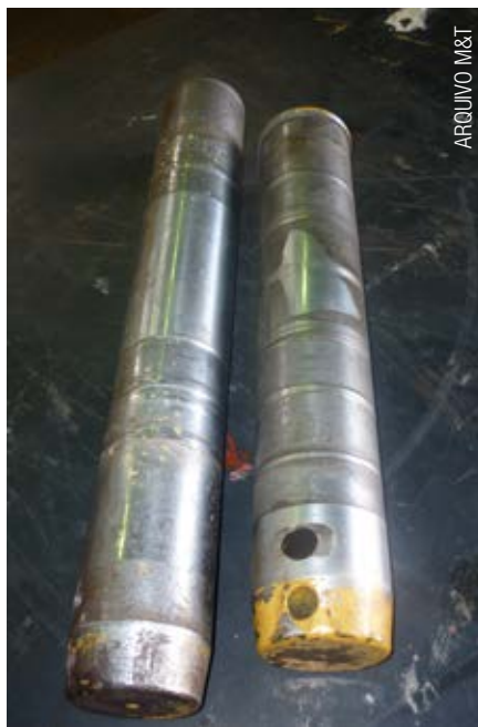
Desgaste diminui vida útil dos pinos
