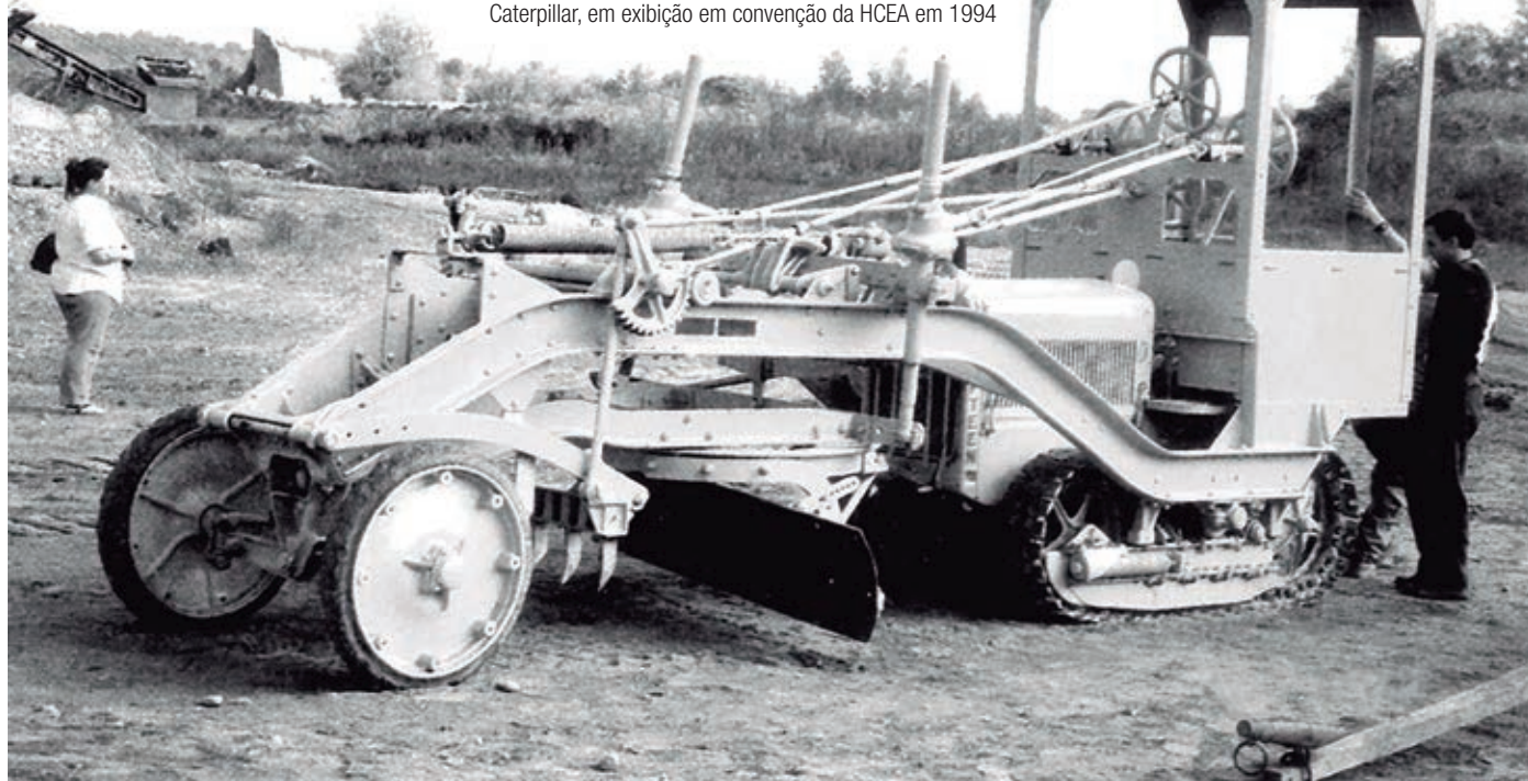
Motoniveladora Russell Patrol , montada em um trator Caterpillar, em exibição em convenção da HCEA em 1994
