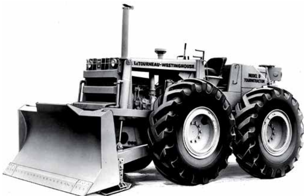
Com 143 hp, o Tournatractor Model D foi considerado uma grande inovação para operações de terraplanagem
