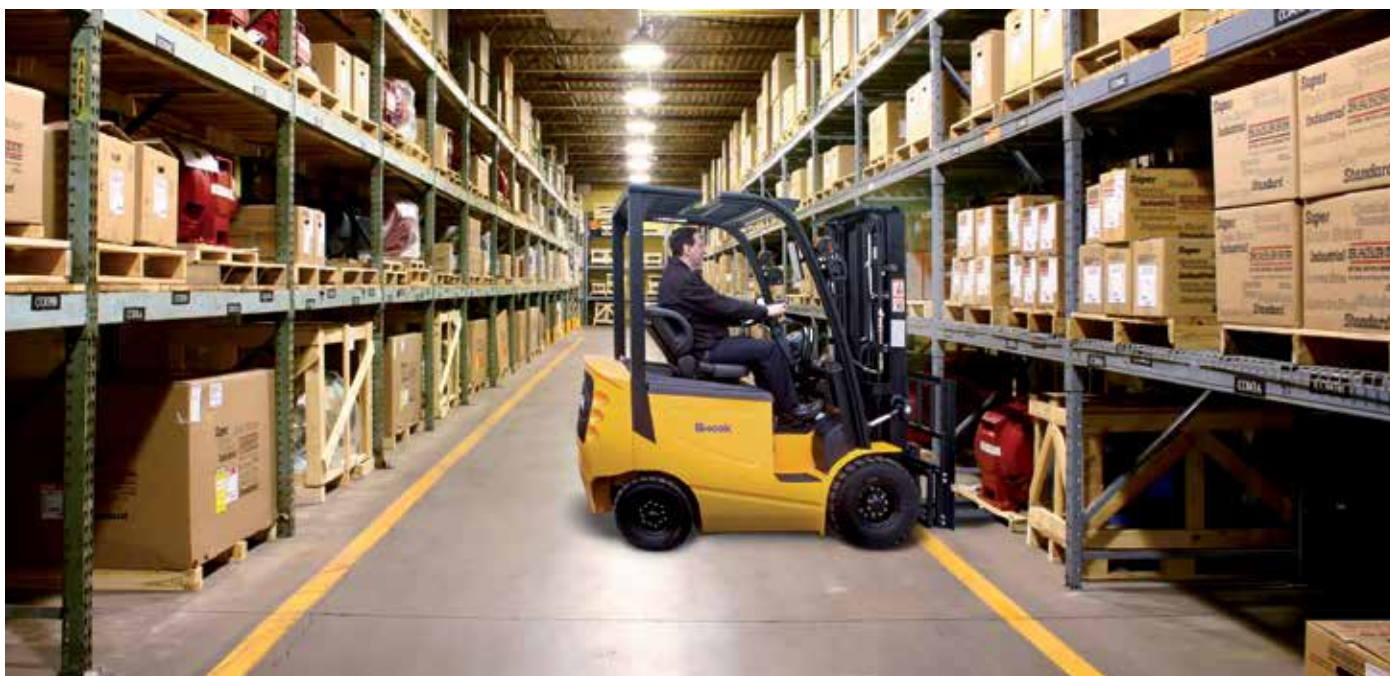
Modelos com propulsão elétrica são os mais apropriados para locais abrigados e com piso regular
