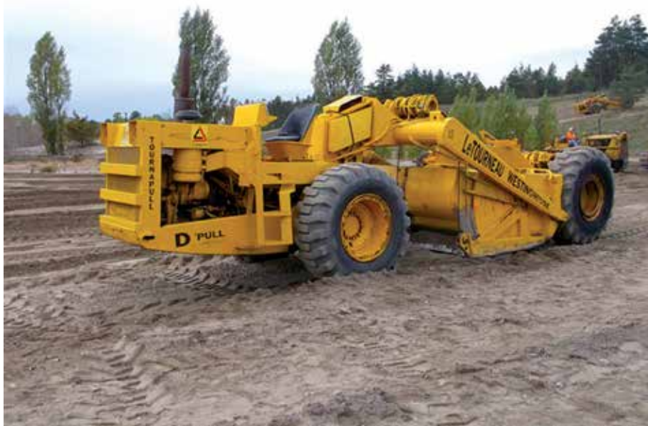
O Tournapull series C foi a mais difundida versão de motoscraeper na década de 40
