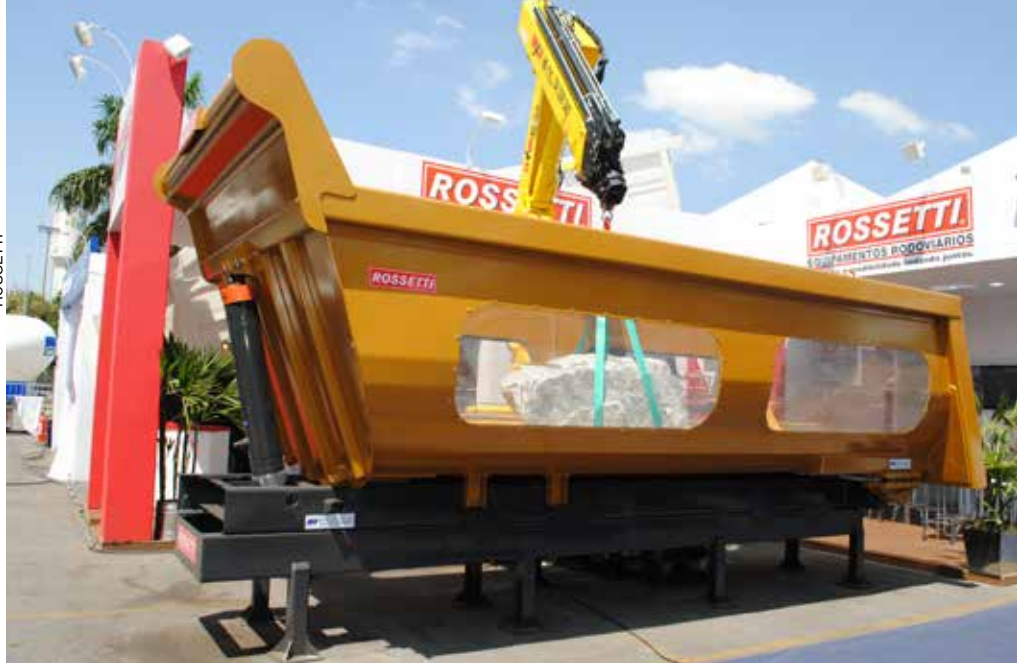
Com margem mínima de erro, caçamba meia-cana faz a pesagem durante o processo de carregamento
