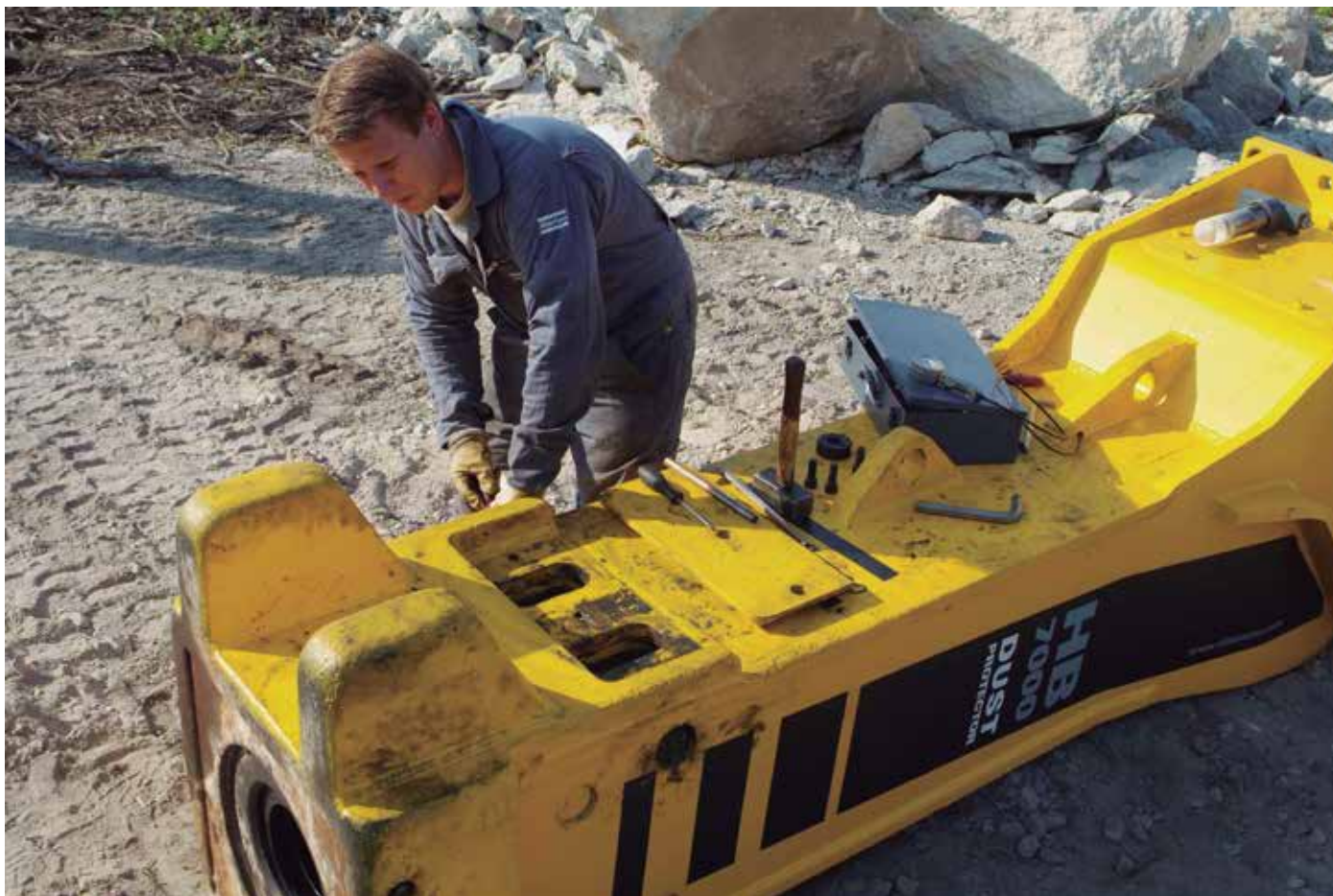
Uso de veículos portadores inadequados pode provocar danos ao implemento, exigindo intervenções de manutenção corretiva
