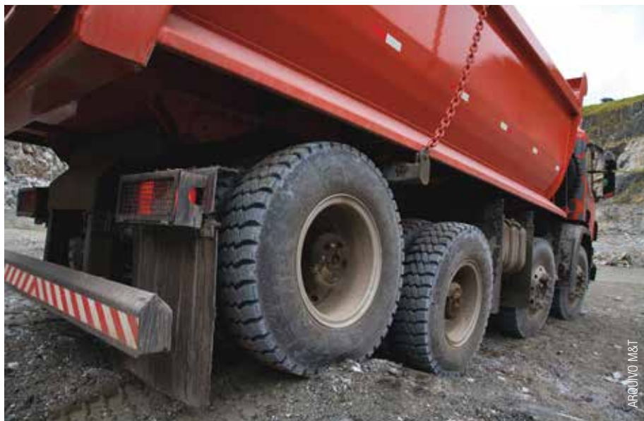
Ondulações ou depressões no solo são absorvidas pelo conjunto
