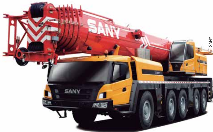
Modelos AT possuem melhor relação entre espaço para manobras e capacidade de carga
