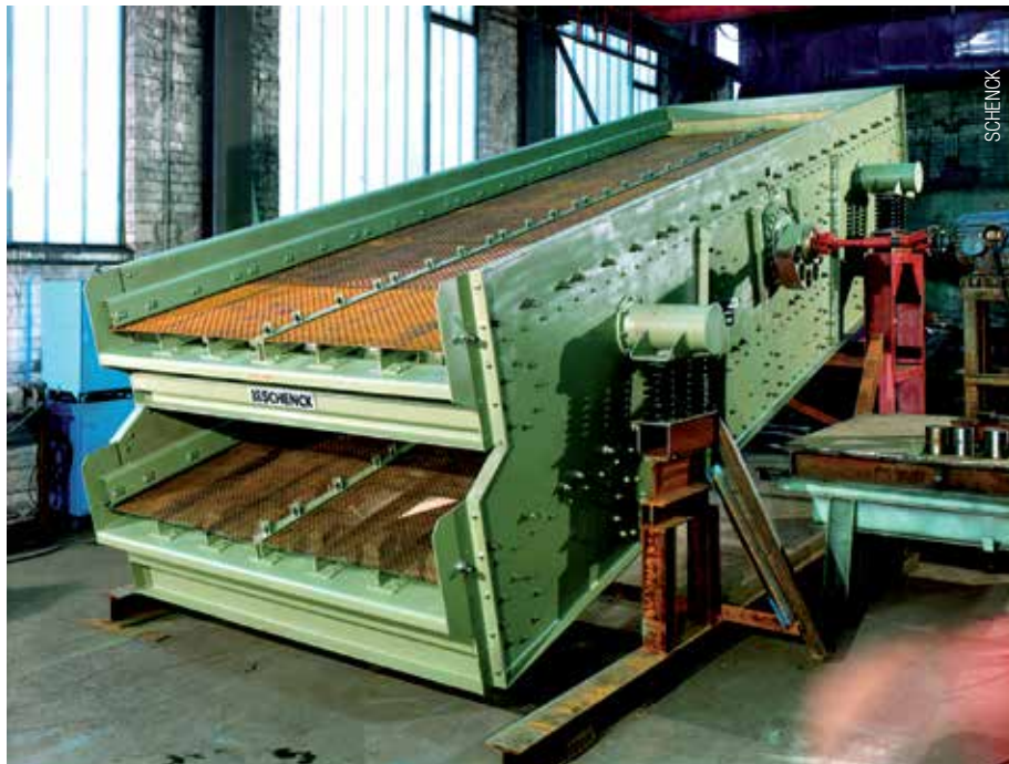
Com o tempo, peneiras vibratórias sofrem desgastes e exigem o acompanhamento de sua integridade
