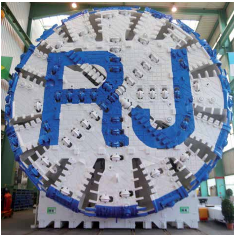
A TBM que fará os túneis subterrâneos da linha 4: maior equipamento a já operar em terras brasileiras
