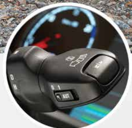
Seletora de marchas Shift by Wire integrada ao painel de instrumentos
