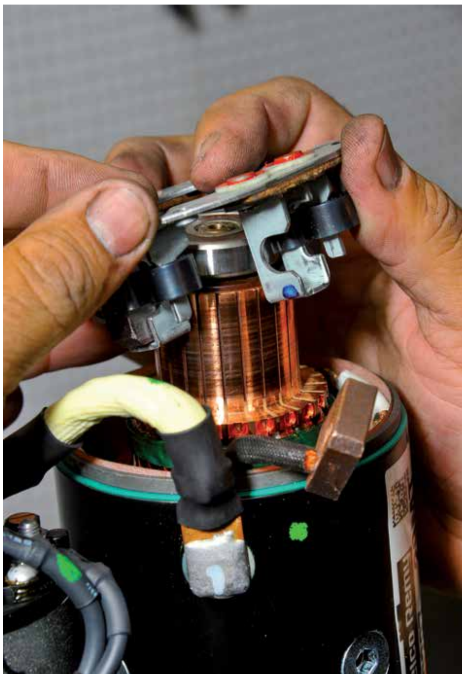
Encaixe de porta-escovas durante a montagem: necessidade de qualificação
