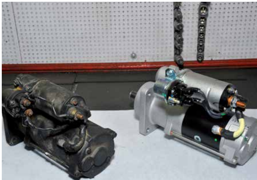
Diferença de aspecto entre um motor de partida usado e novo: desgaste intenso
