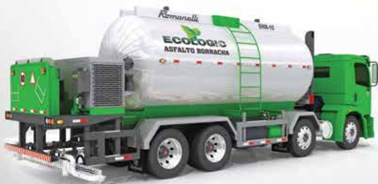
EHR 15 ECOLOGIC ESPARGIDOR HIDROPNEUMÁTICO PARA ASFALTO BORRACHA
