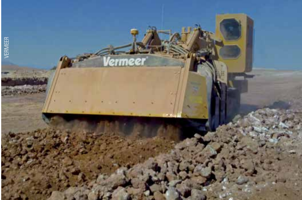
Minerador de superfície elimina a necessidade de explosivos no desmonte de rocha
