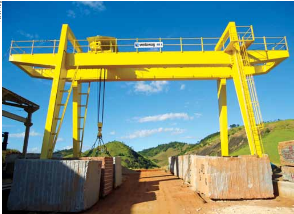
Estrutura dos equipamentos é feita com chapas de aço reforçadas
