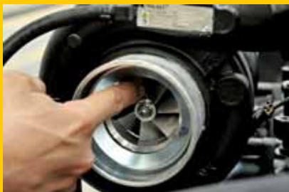
Inspeção do turbo compressor
