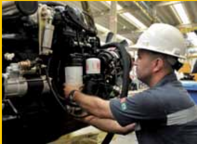
Verificação do filtro de óleo
