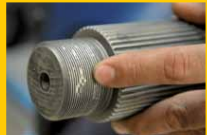
Eixo do câmbio com avaria na rosca
