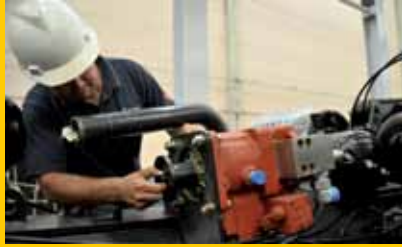
Inspeção da bomba hidráulica
