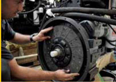
Colocação de nova embreagem
