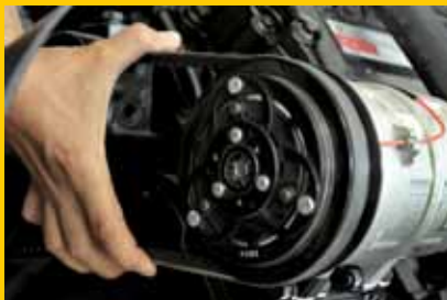
Verificação de folga de correia
