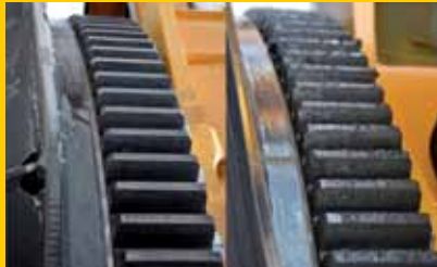
Roda dentada da plataforma de giro (antes e após lubrificação)
