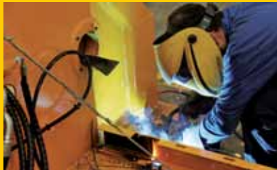
Solda MAG na estrutura do chassi
