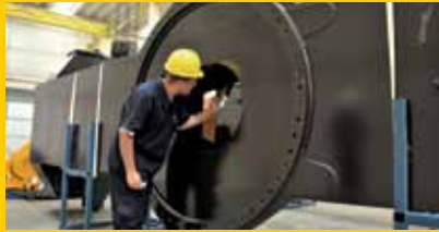
Inspeção no recorte da plataforma de giro
