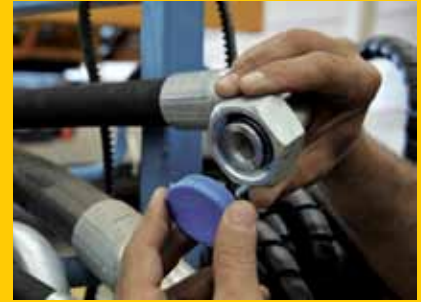
Mangueira hidráulica com proteção de plástico
