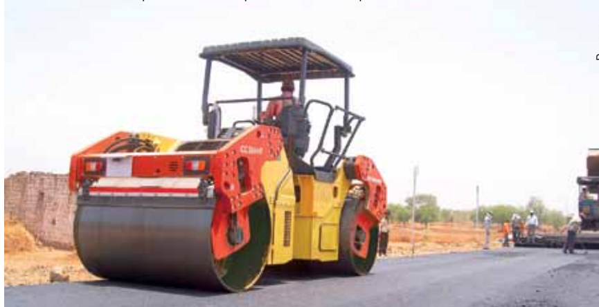
Rolos tandem incorporam tecnologias como o GPS e compactação inteligente
