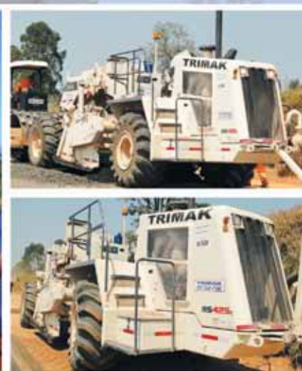
Estabilização de solo
