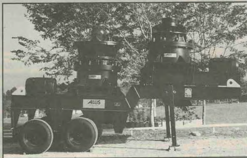
Britadores Hydrocones montados em conjunto móvel
