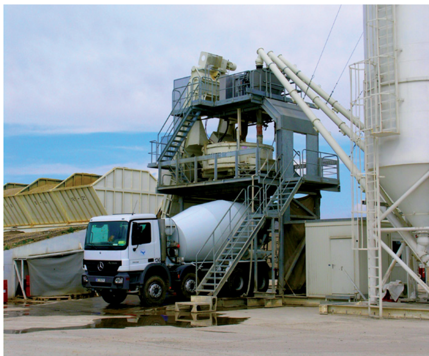
Parte vazia no balão permite que o tombo do concreto ocorra de forma eficiente
