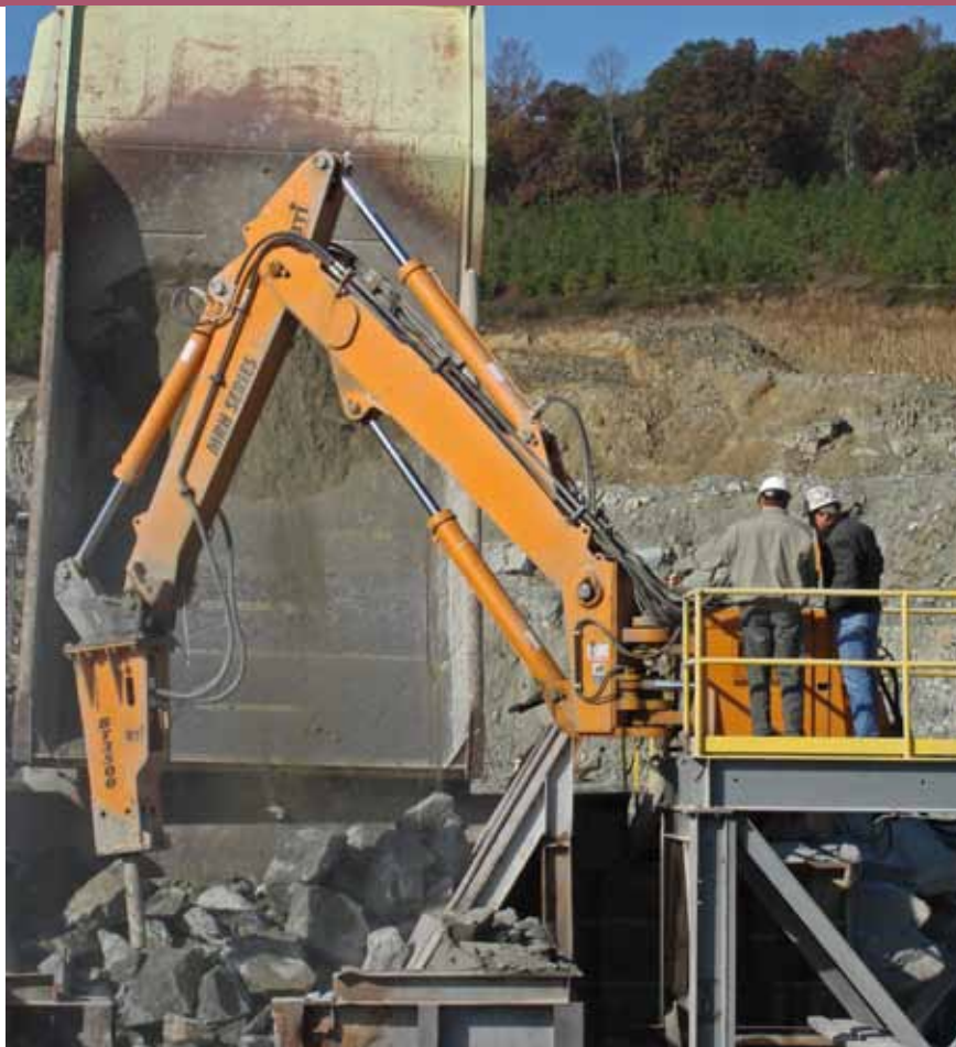
Braço hidráulico da Astec: otimiza a alimentação da britagem
