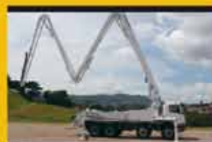
Autobomba de Concreto com lança
