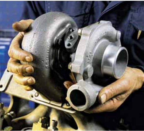
Cinco segundos sem lubrificação são suficientes para danificar o turbo
