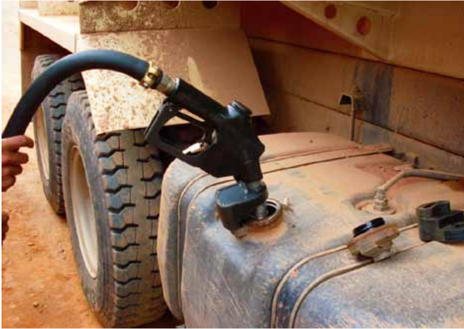
Sensores no bico da bomba e no tanque controlam o abastecimento
