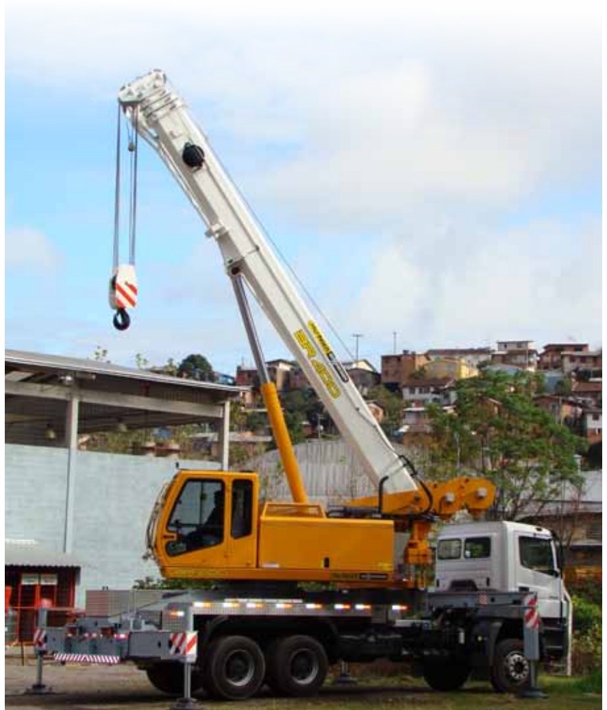
Lanças de guindastes ficaram mais leves e longas proporcionando controle sobre a deflexão elástica
