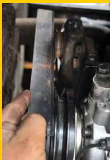
1 Verificação do alinhamento das polias com o uso de uma régua
