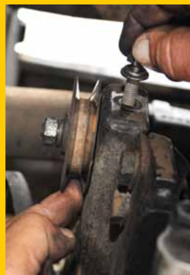
2 Remoção do parafuso de ajuste do esticador da correia
