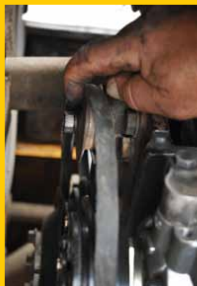
3 Colocação da correia
