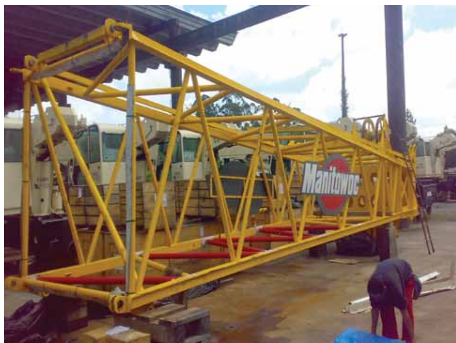
Pintura adequada também protege os elementos estruturais
