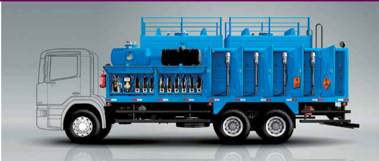
Comboio com tanque de diesel independente da estrutura: flexibilidade no layout
