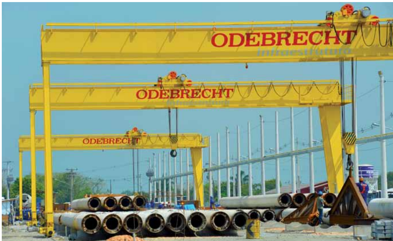
Fábrica de pré-moldados: com 12 pórticos de 35t cada
